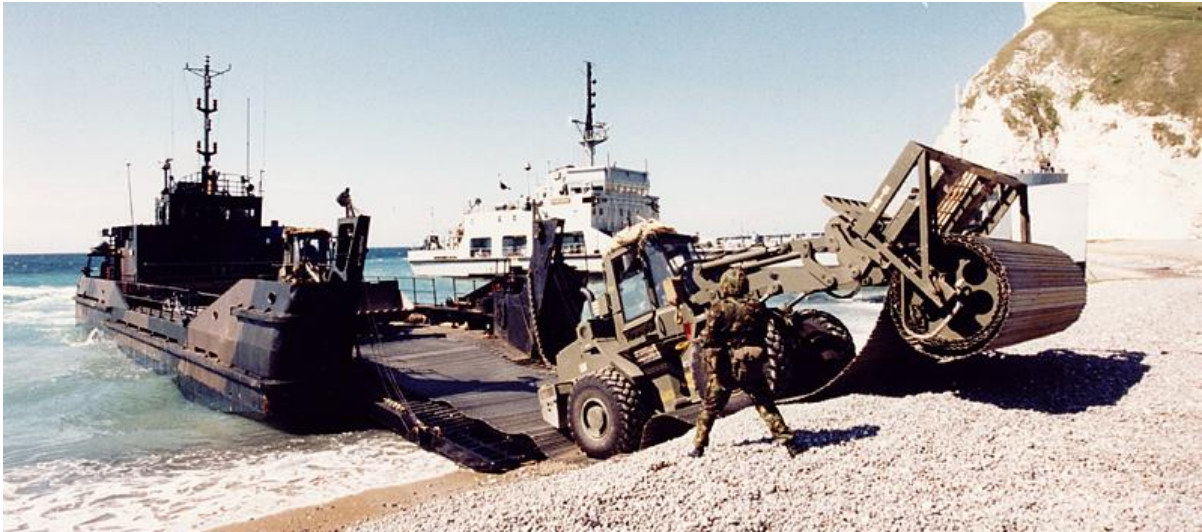
Az MLC 30 útpálya telepítése a hídfő megerősítésére 28
