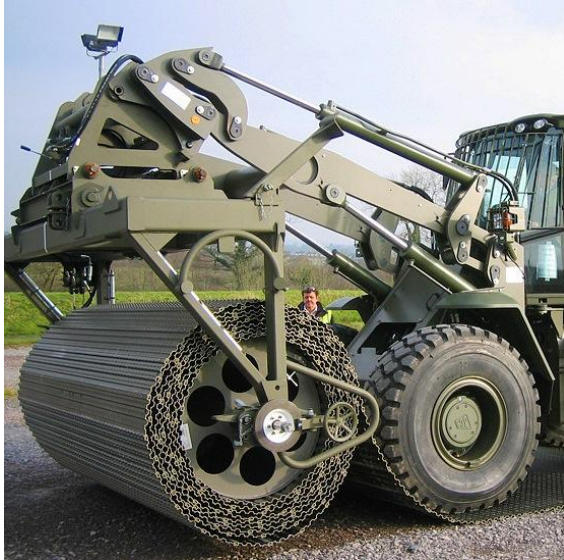
A BEACH DISPENSER telepítő berendezés 22
