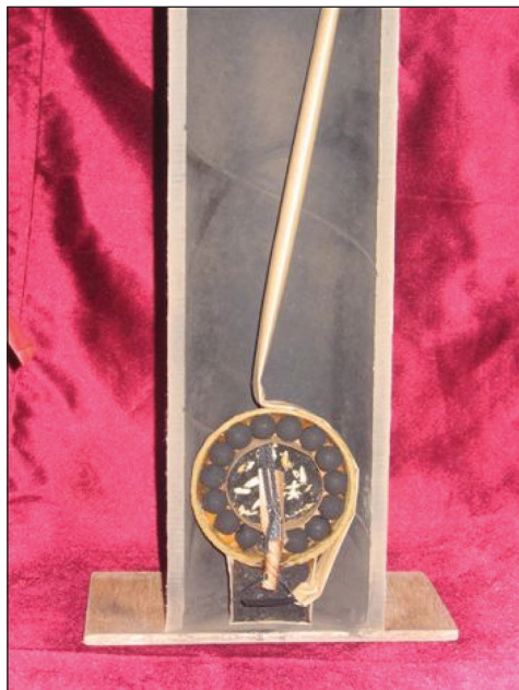
12. ábra: Vetőcsöves tűzijáték keresztmetszeti sémája [8]
