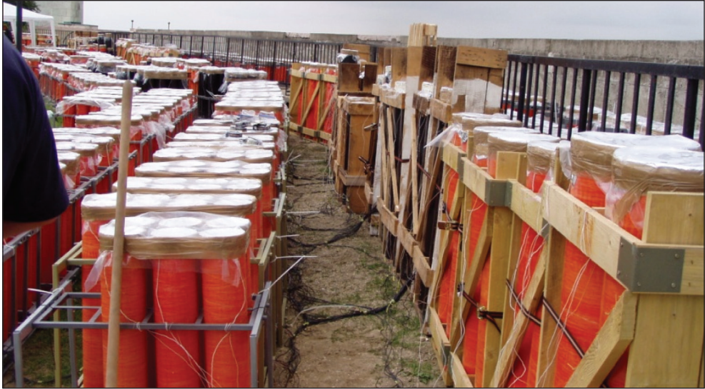
14. ábra: Fa és fém kalodában elhelyezett, 125-200 mm-es vetőcsövek (Készítette: Patyi György)
