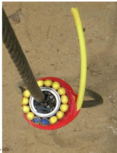
7. sz. ábra: Ø12 mm-es acélsodrony kötél szerelése elektromos illesztő-betéttel, illetve kiegészítő alumínium rudakkal 15
