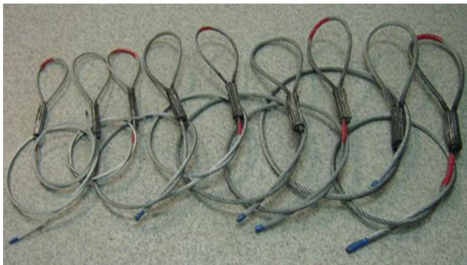
14. számú ábra: Különböző átmérőjű, robbantott drótkötél hurkok ( \varnothing 6–8–10–12 mm) 22
