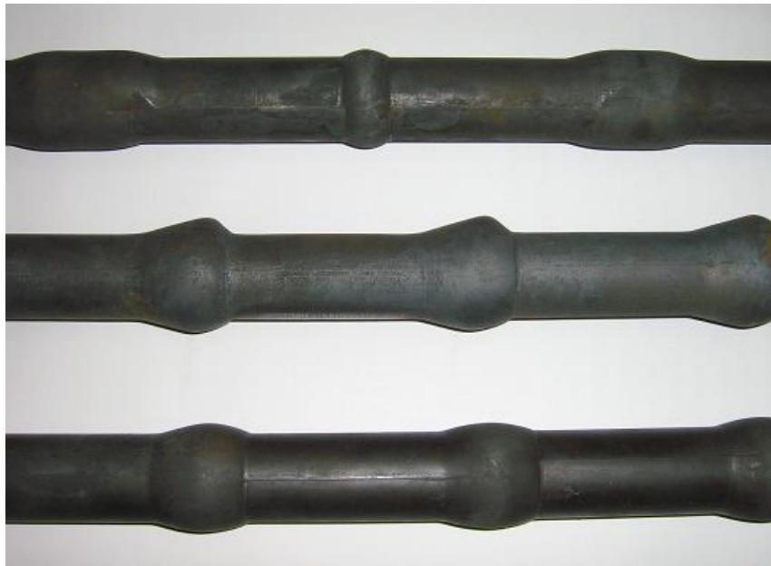
14. ábra Robbantással készített hőcserélő cső változatok
