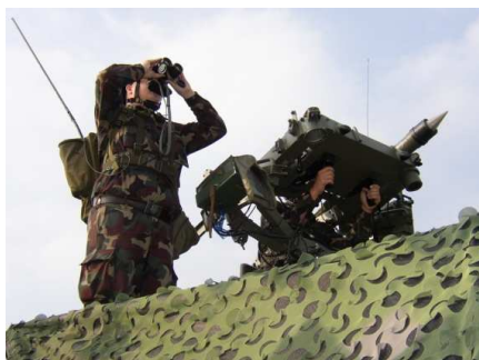
11. ábra ATLAS indítóállvány MISTRAL-2 rakétával 13 [11]
