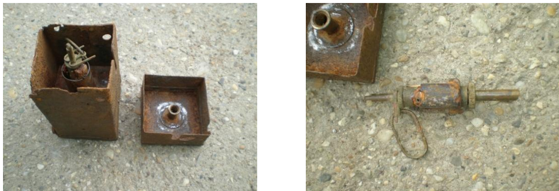
Zubovics-féle torpedó és gyújtószerkezete [28]
