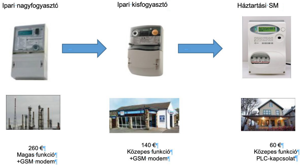
11. ábra: Távleolvasható fogyasztásmérők evolúciója (Forrás: Internet.)
