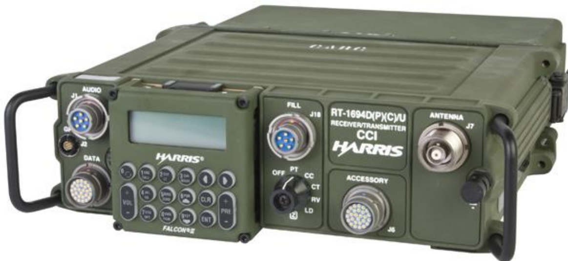
2.2. kép. AN/PRC-150(C) HF-VHF korszerű harcászati rádió (forrás: [100])
