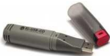
3. ábra LASCAR EL USB CO datalogger
