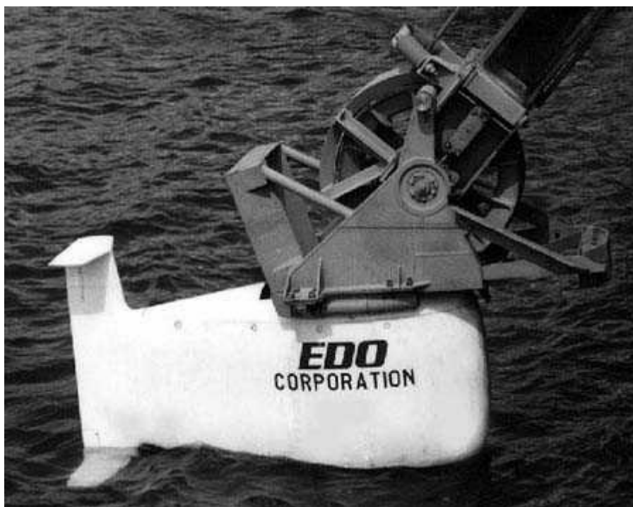
8. sz. ábra. Vontatott kialakítású passzív hidrolokátor
