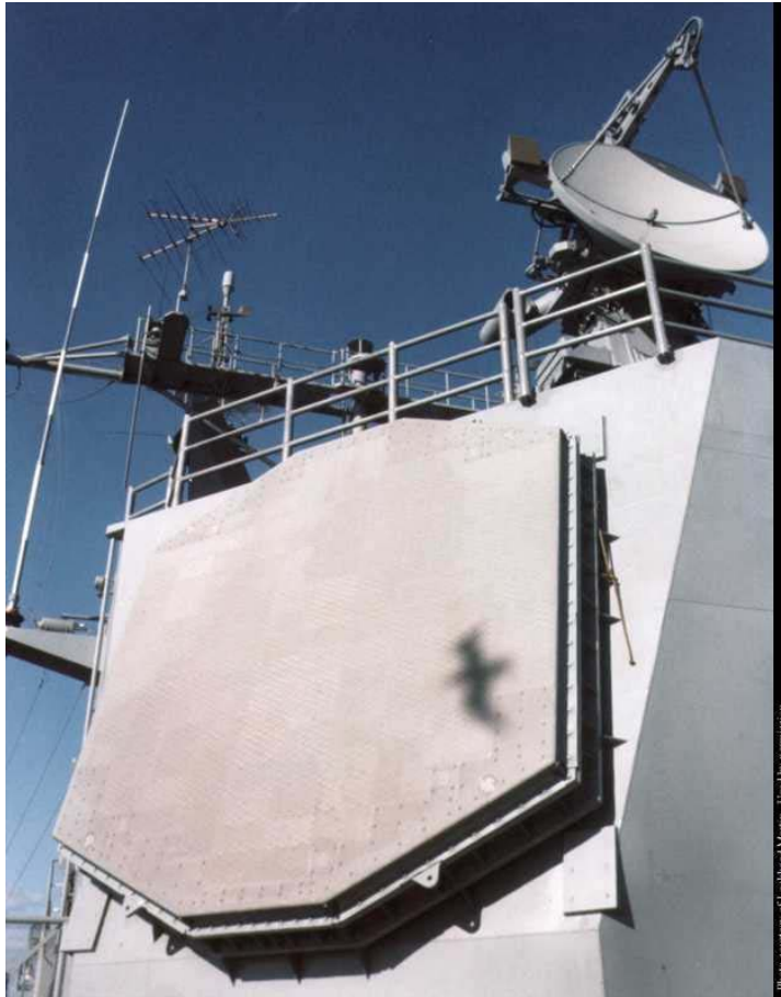
1. sz. ábra. A SPY-1 típusú lokátor sík kialakítású fázisvezérelt antennája
