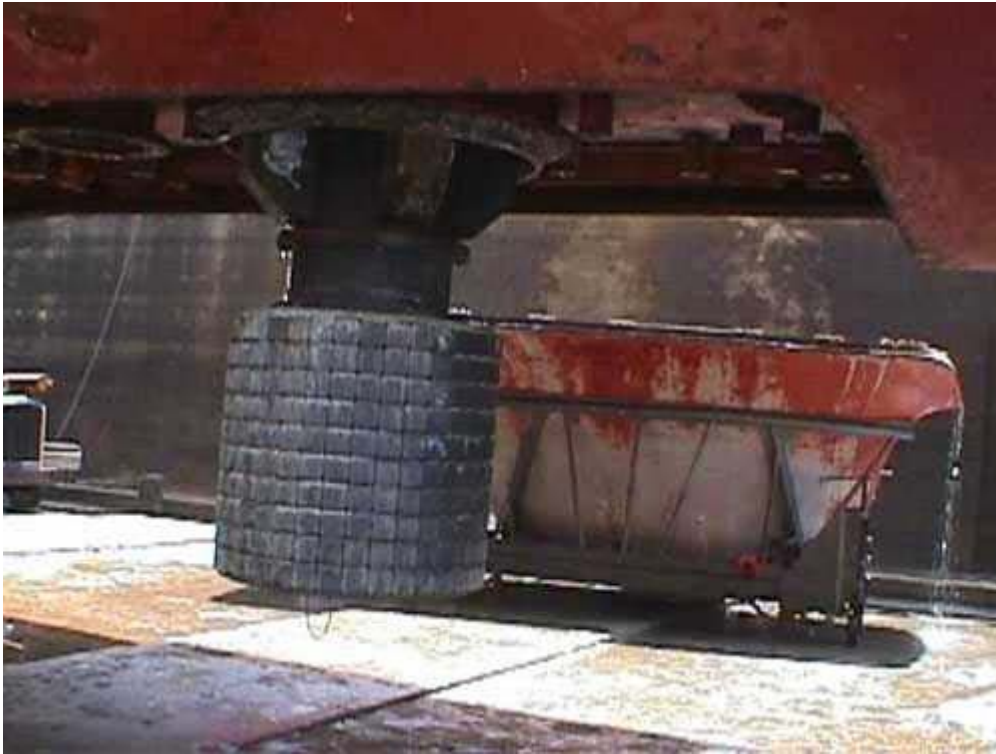
9. sz. ábra. EDO 997-es hajótörzsbe épített hidrolokátor érzékelő tömbje
