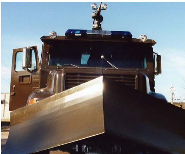
7. kép: Alpine Riot Control szemből nézve, barrikád eltávolító ekével http://www.alpineco.com/armored/riotcontrol/truck.html
