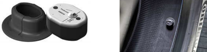
4.5 ábra. Az érzékelő és gumifoglalat, valamint a felhelyezése [16] [17]
