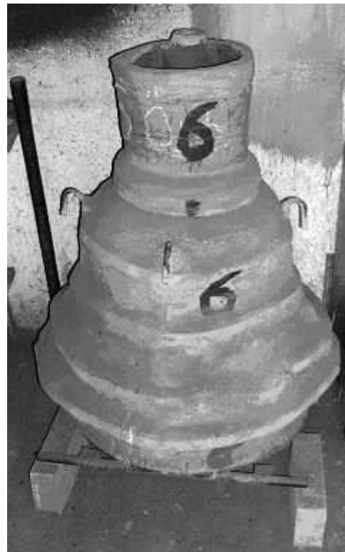
3. kép: Kész harang-öntőforma 11
