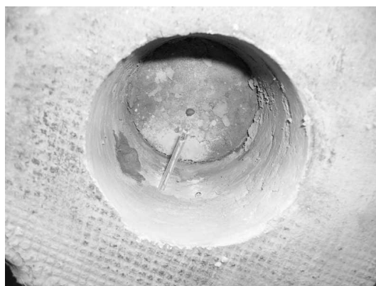
A kísérlet elvégzésére szolgáló forma belseje a belógó mérőfejjel
