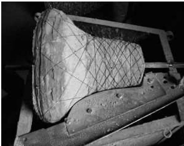
2. kép: Az álharang formázásának kezdete
