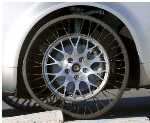
4.5 ábra. Defektmentes gumiabroncs 11
