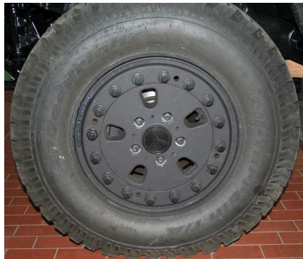
4.4 ábra. G280 CDI defekttűró gumiabroncsa 10
