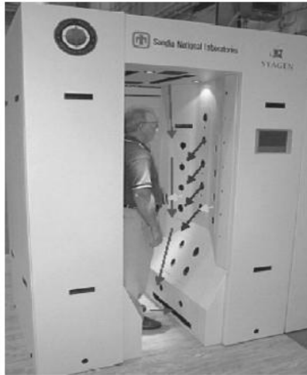
11. ábra: MS-alapú beléptető rendszer
