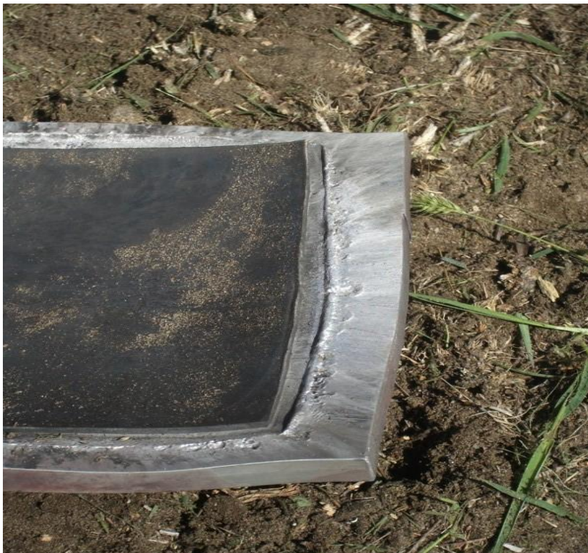
8. ábra: Az alaplemezen látható a kifröccsent olvadék 3
