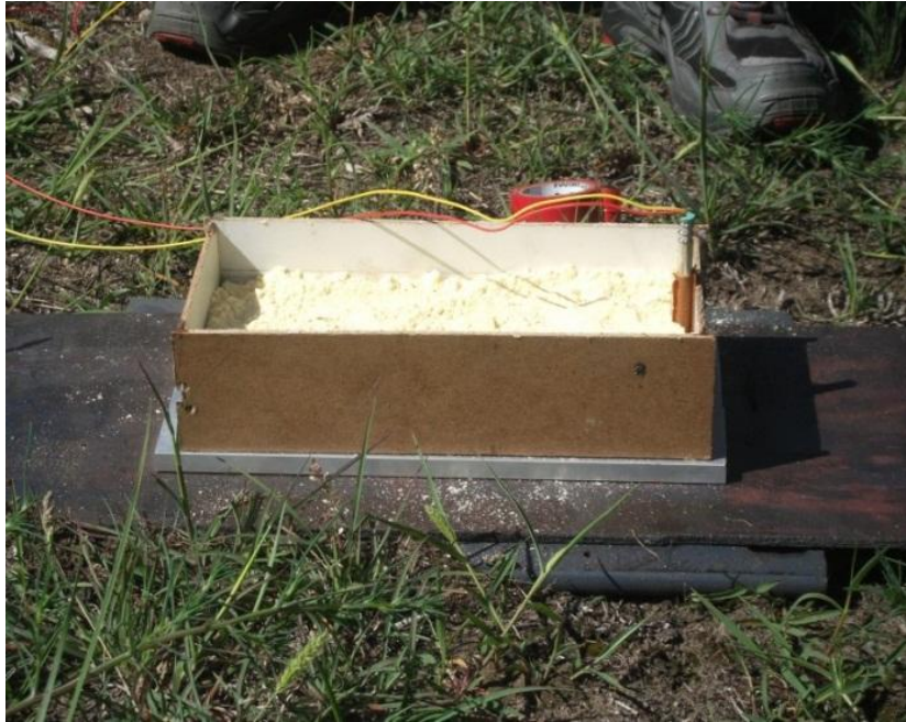
7. ábra: A lemezek és a robbanóanyag elrendezése
