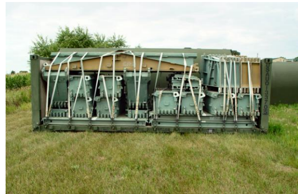
23. sz. kép Hídelemek az M1 „flatrack”-en 34
