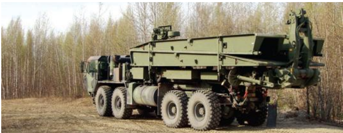
17. sz. kép REBS az M1977 Szabványos hídszállító járművön 36
