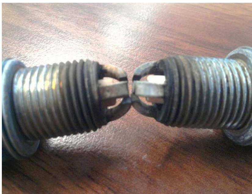
1. ábra. Jól látható szín eltérés a gyújtógyertyákon
