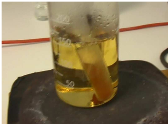
6. ábra. 200°C-ra hevített motorolaj
