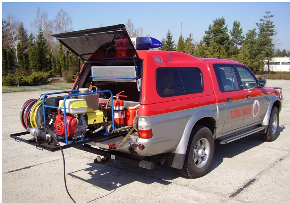
1. sz. kép. A Mitsubishi L-200 gépkocsira málházott UNIJET-FOG vízköddel oltó berendezés
