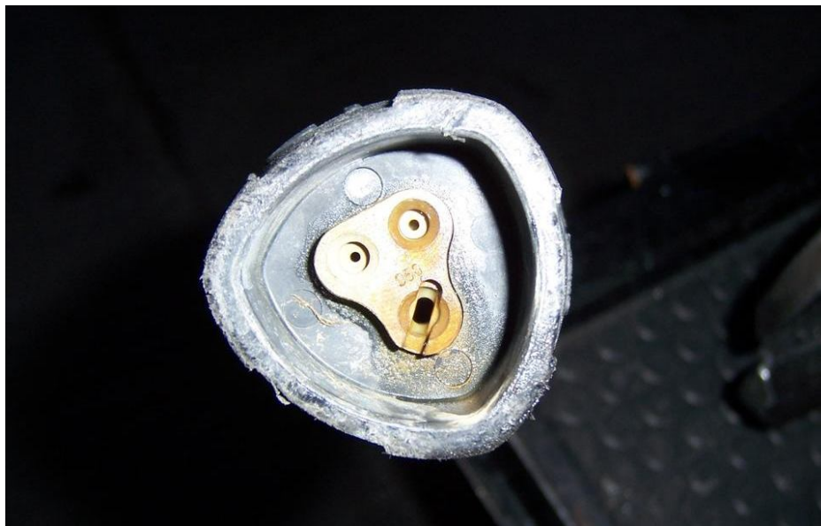
3. sz. kép. A különböző sugárképek kialakítására alkalmas fúvókák
