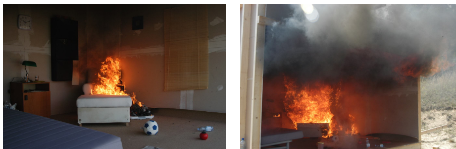
6-7. kép. A pécsi könnyűszerkezetes tűzoltó gyakorlóépítmény kezdeti tűznél és „füstpaplan” kialakulásakor Forrás: HÖT Pécs, 2009.
