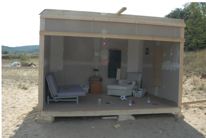
5. kép. Zárt téri tüzek vizsgálatára épített „tűz-cella”. Forrás: HÖT Pécs, 2009.
