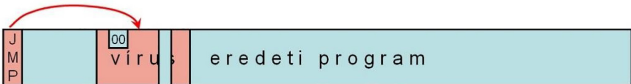
13. ábra: .COM állomány fertőzése méretnövekedés nélkül
