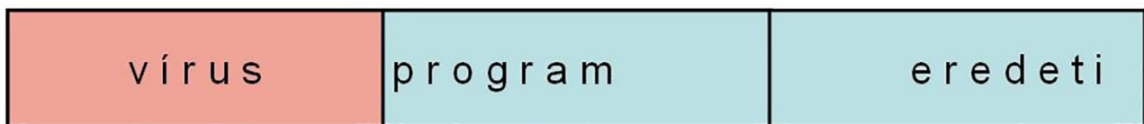
11. ábra: .COM állomány fertőzése (a kártevő a fájl elejére írja magát - II)
