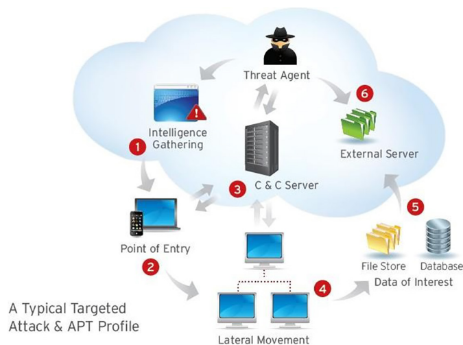
28. ábra: Egy tipikus célzott támadás és az APT (Advanced Persistent Threat) felépítése
