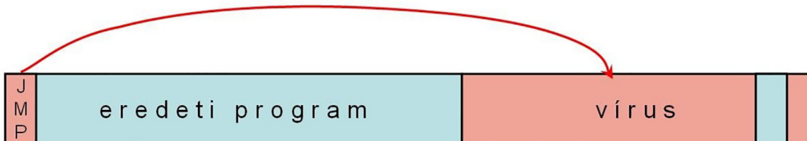
9. ábra: .COM állomány fertőzése (a kártevő a fájl végére írja magát)
