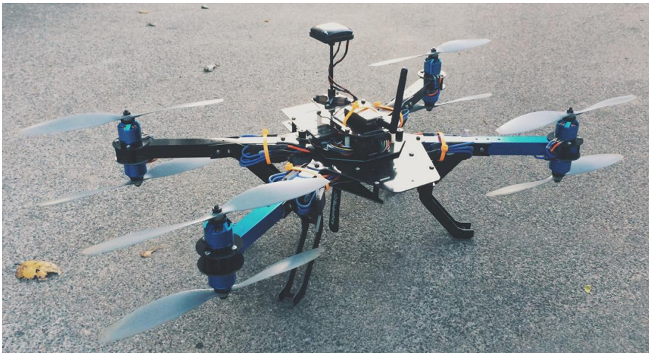
Ábra 3: A drón tetejére szerelt GPS vevő
