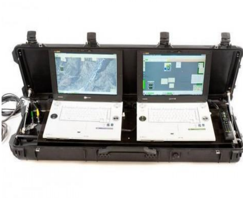
15. ábra RPA „Orlan-3M” hordozható földi irányító állomása
