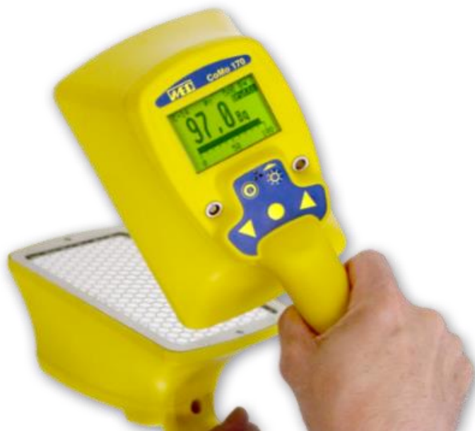
8.számú kép Kontamináció/Szennyeződés Mérésére alkalmas COMO 170 típusú műszer (Forrás: Internet http://www.graetz.com/como-170+M5c7c9be568f.html )
