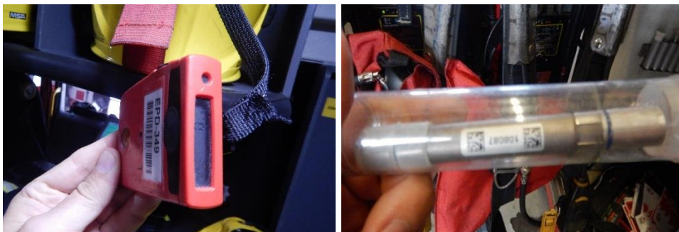
9-10.számú kép Személyi dózismérő, és elektronikus személyi doziméter különböző tűzoltóságok gépjárműfecskendőin Angliában (Készítette: Pántya Péter)
