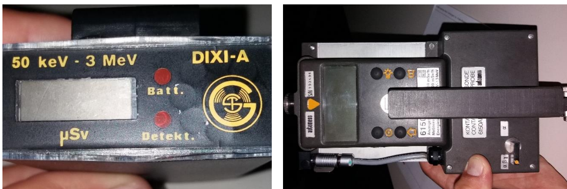
13-14. számú kép Operatív elektronikus dóziméter, felületi sugázmérő Landesfeuerwehrschule Ausztria Eisenstadt (készítette: Rácz Sándor)
