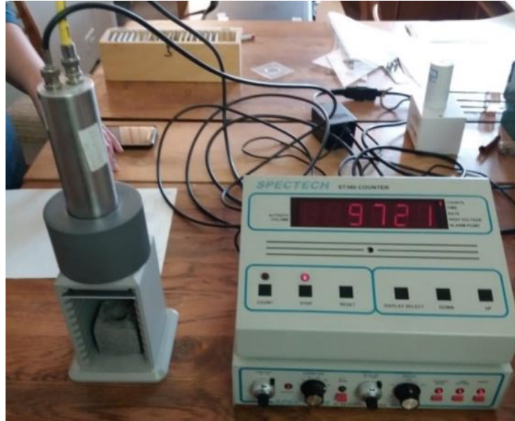
5.számú kép Sr-90 izotóp beütésszám mérése Spectech szcintillációs detektorral. (Készítette: Rácz Sándor)
