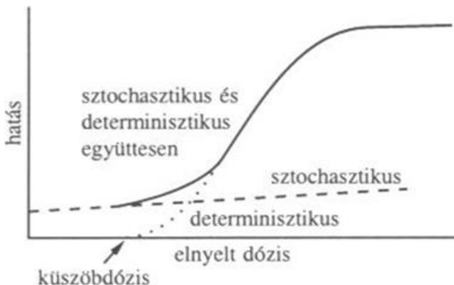
11. ábra Sztochasztikus és determinisztikus hatások alakulása az elnyelt dózis függvényében. [44]
