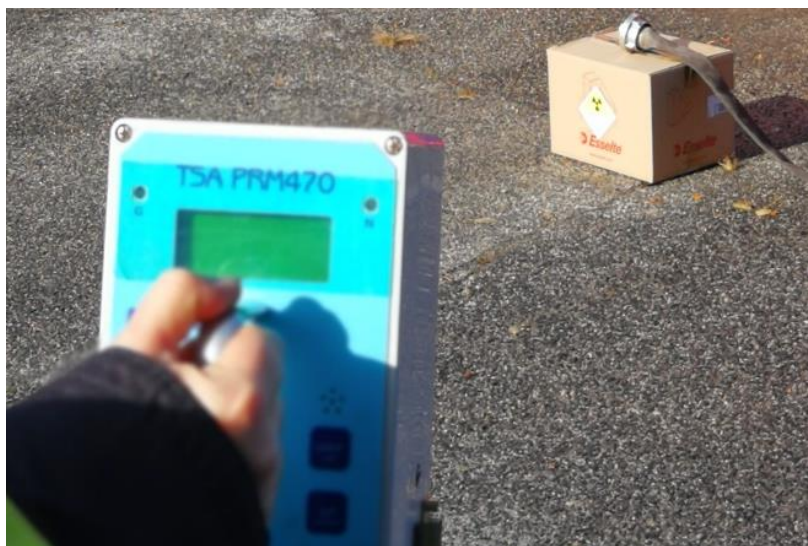
20.számú kép A méréshez használt TSA PRM470 dózisteljesítmény mérő műszer és a „sugárforrás” (Készítette: Rácz Sándor 2018. október 29.)
