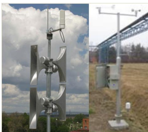
2. fénykép: MoLaRi rendszer riasztó és vegyi monitoring végpontjai, forrás: Gamma Műszaki Zrt.
