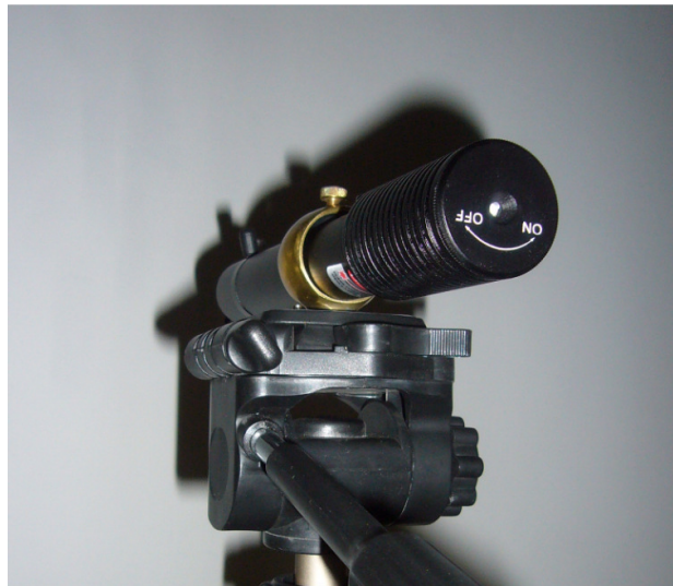
15. kép: Az 589 nm-es 50 mW-os lézerberendezés földi szimulációs kísérlet elvégzésére (Készítette: a szerző) [15]
