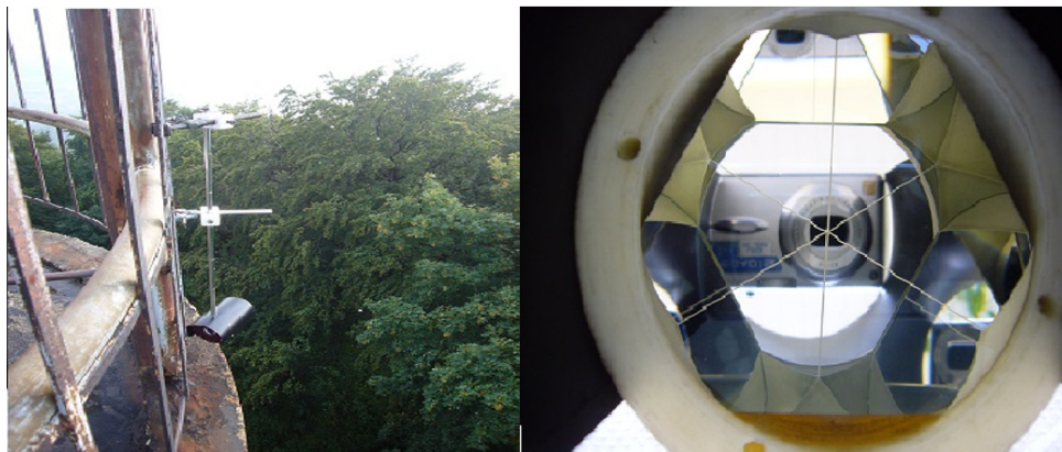
43. kép: A sarokprizma (bal oldalt) és az felszerelve a Zengőn lévő kilátó külső oldalára (jobb oldalt) (A szerző felvétele)
