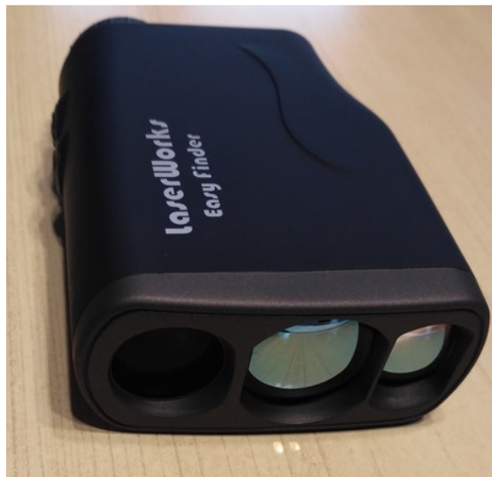
1. kép: 905 nm-en működő lézeres távmérő (A szerző felvétele)
