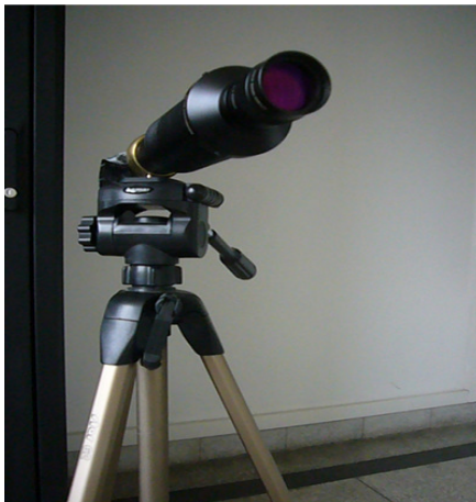
20. kép: A mérésekhez használt 532 nm-es lézer sugárnyalábpárhuzamosítóval (beam expander) ellátva (Szerző felvétele) [158]
