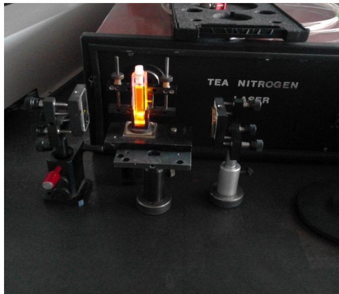
29. kép: A TEA nitrogén lézerrel gerjesztett festéklézer (A szerző felvétele)
