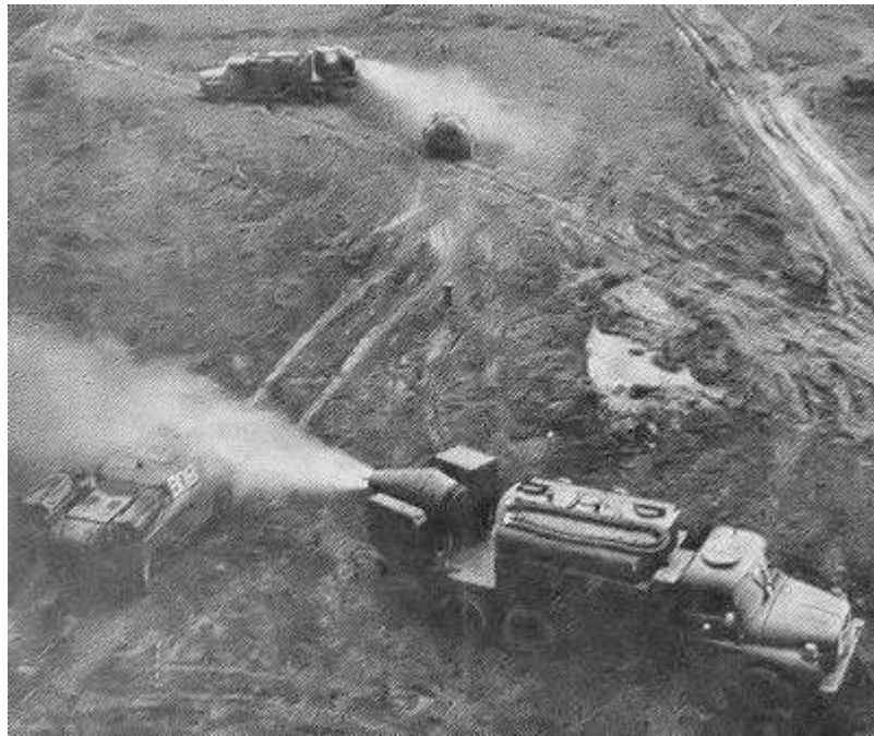
9. számú kép: TZ-74-es hőlégsugaras mentesítő gépkocsi mentesítési szakfeladat végrehajtása közben
