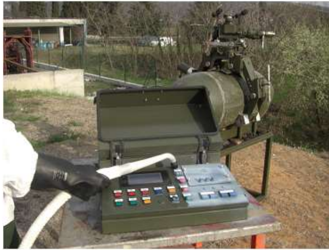
25. számú kép: A CRISTANINI gyártmányú multi-fázisos aeroszol alapú érzékenyeszköz mentesítő berendezés
