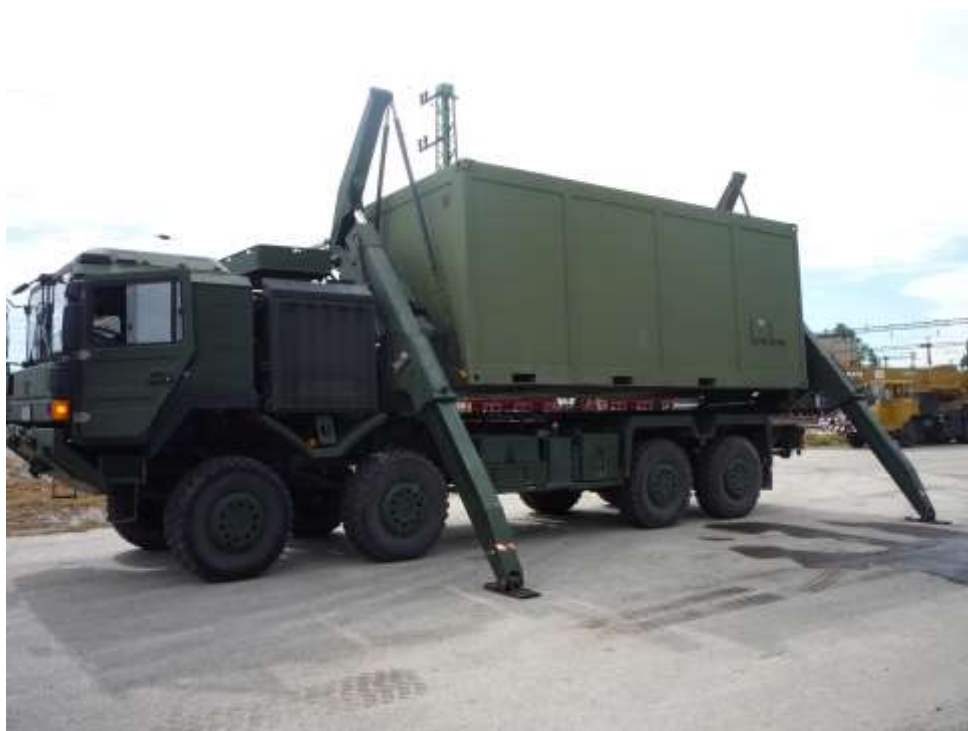
15. számú kép: A Mentésítő Anyagszállító Konténer MAN HX-32 konténerszállító járművön málházva
