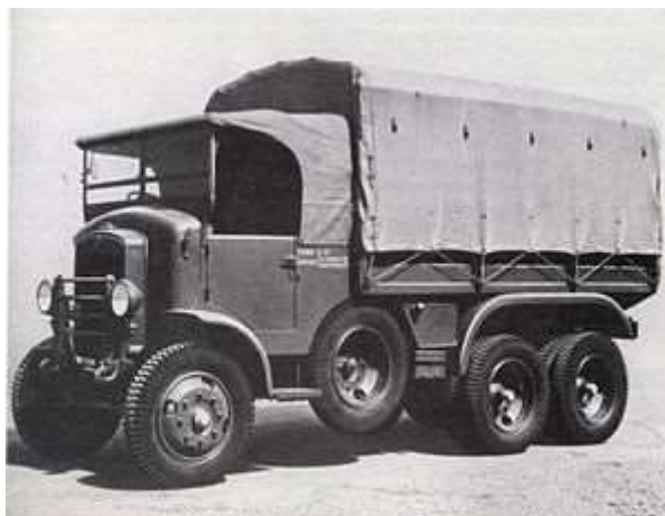
5. számú kép: Fiat Spa Dovunque vegyimentesítő gépkocsi
