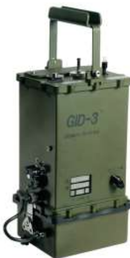
30. számú kép: GID-3 mobil IMS vegyijelző műszer
