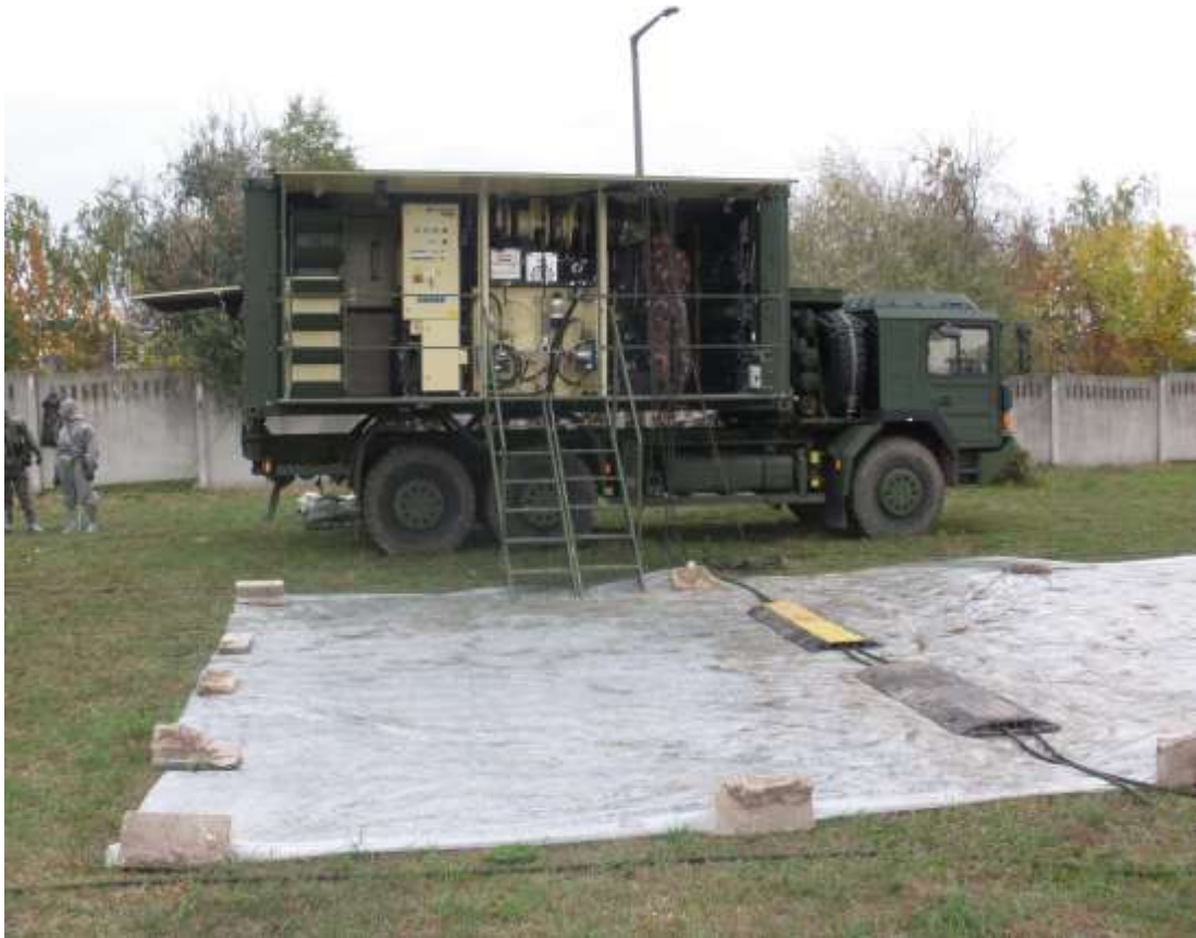
12. számú kép: A Konténeres Mentesítő Berendezés technika mentesítési szakfeladatra történő telepítése
