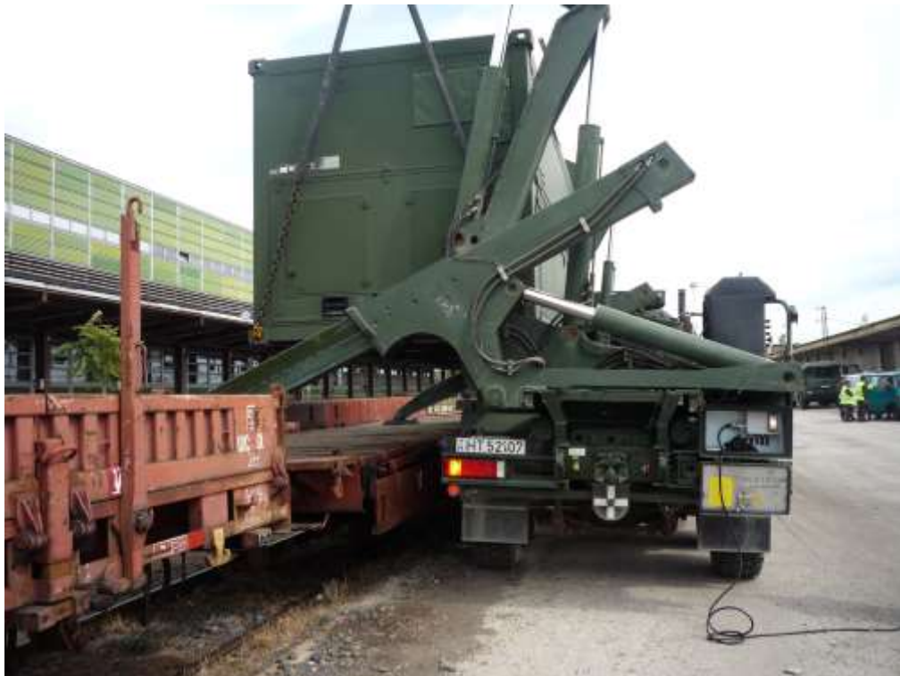
21. számú kép: Az ABV mentesítő konténer vasúti szállítási vizsgálata
