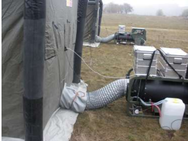
37. számú kép: Forrólevegős mentesítő berendezések (Hot Gas Unit –HGU) felszerelés mentesítésre történő alkalmazás során
