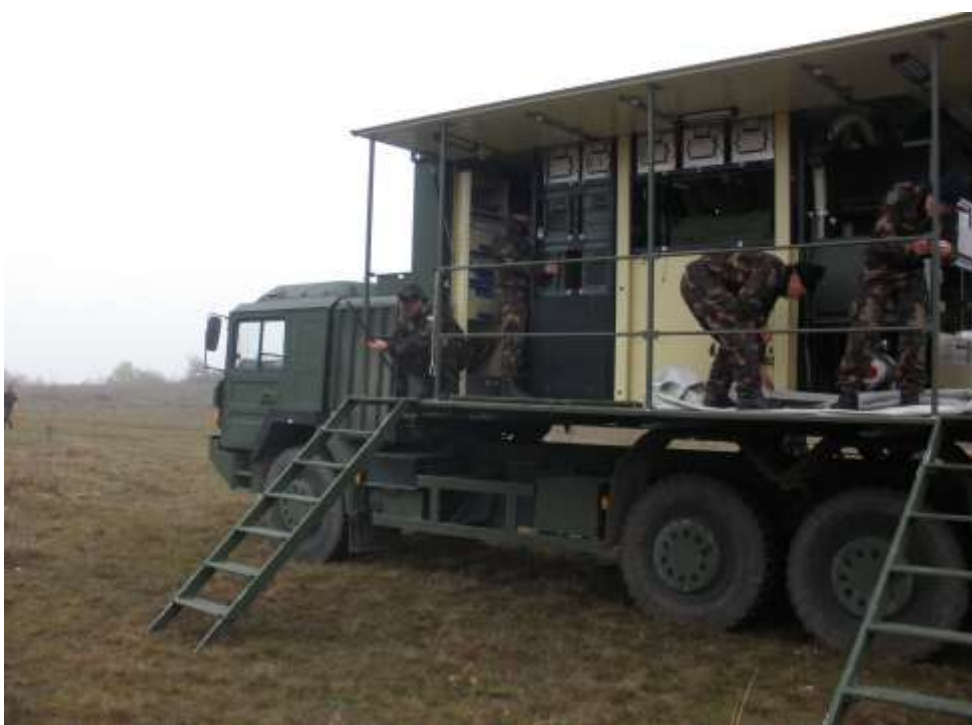
22. számú kép: A Konténeres Mentésítő Berendezés csapatpróba vizsgálatra történő telepítés során
