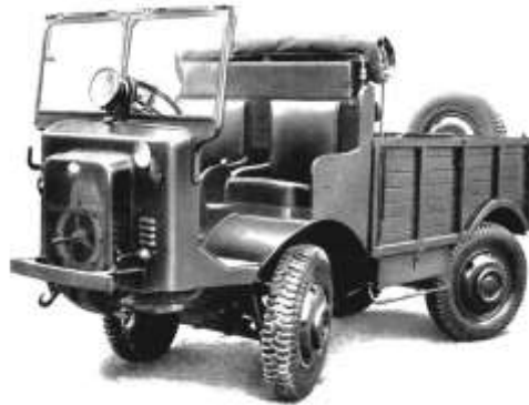
6. számú kép: 6M Autocaretta 32 kisterepjáró vegyimentesítő tehergépkocsi
