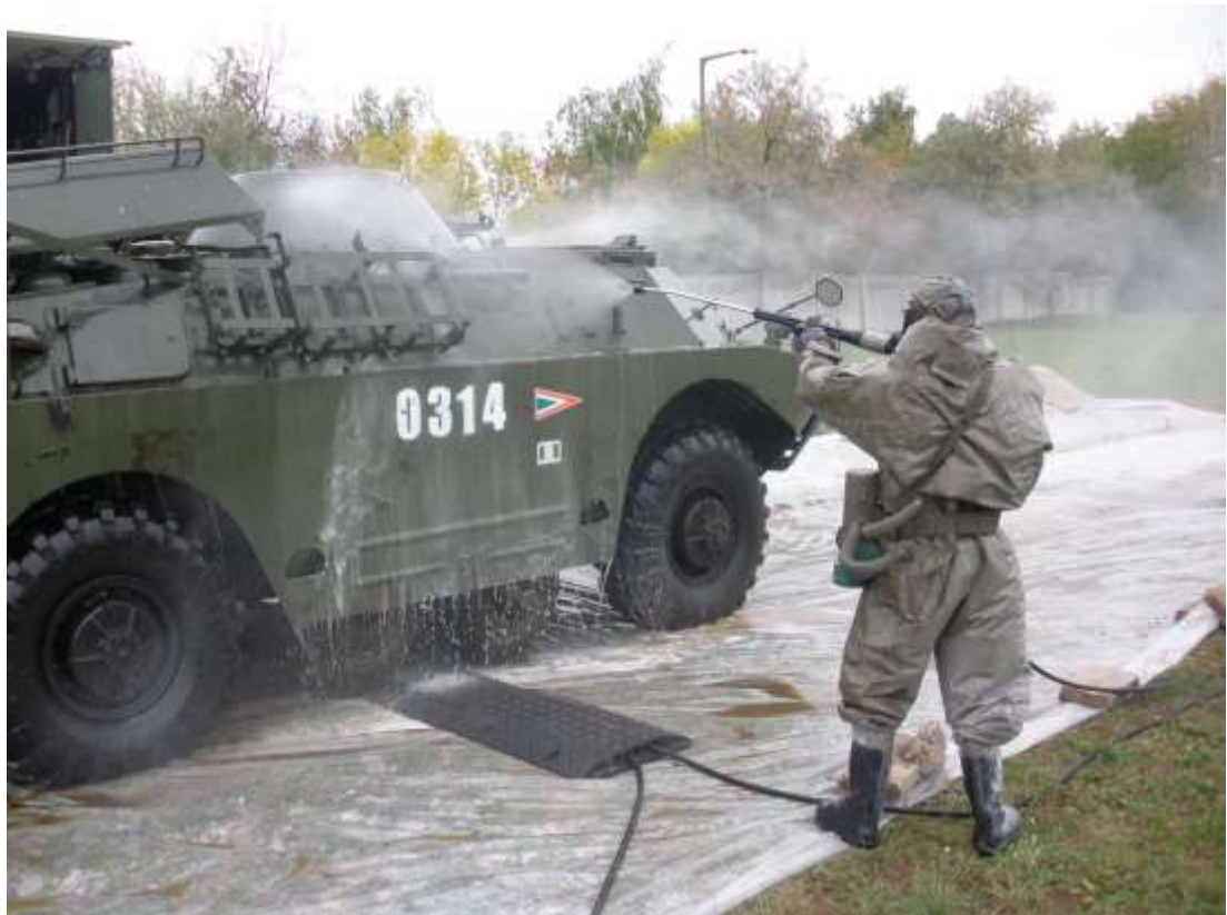
18. számú kép: GDS 2000 mentesítő anyag csapatpróba vizsgálata
