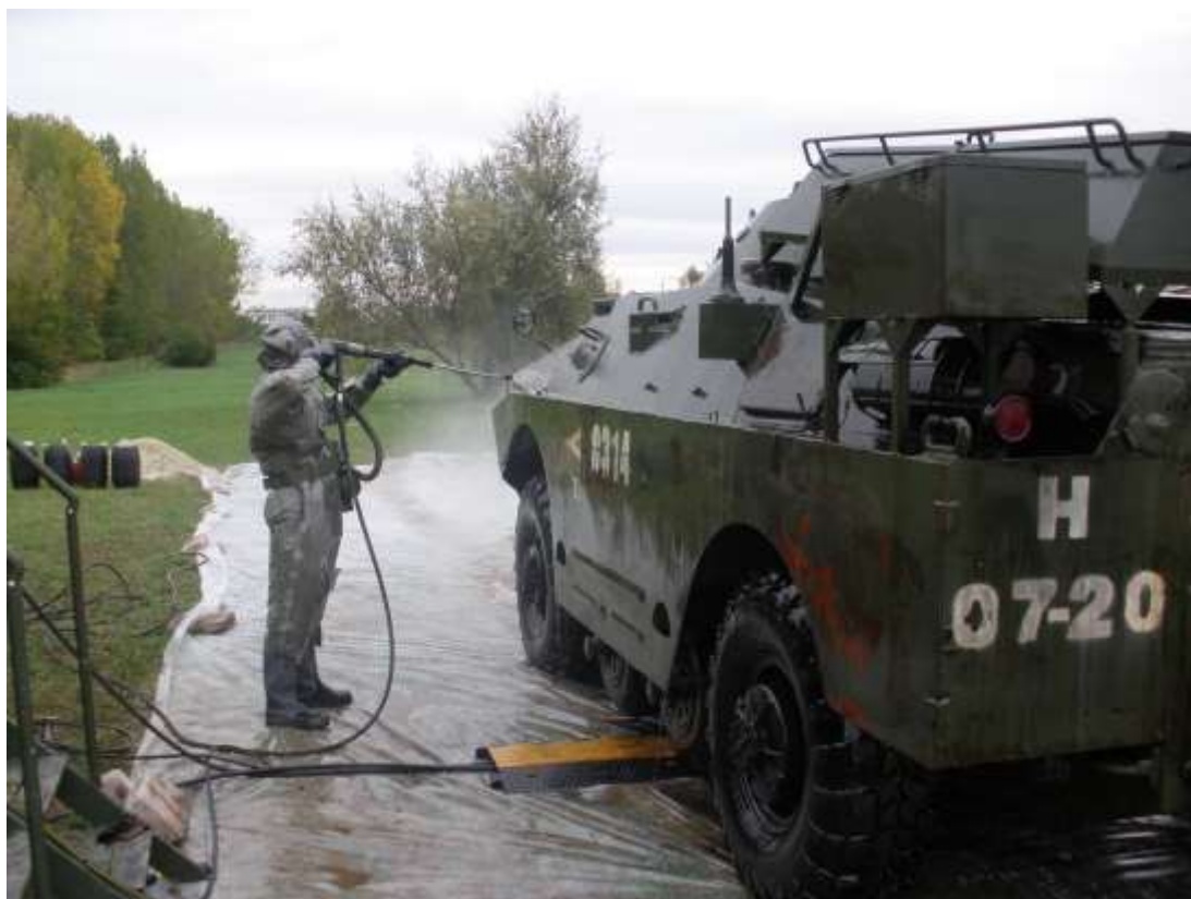
36. számú kép: Vegyimentesítés végrehajtása a technikai eszköz mentesítő helyen
