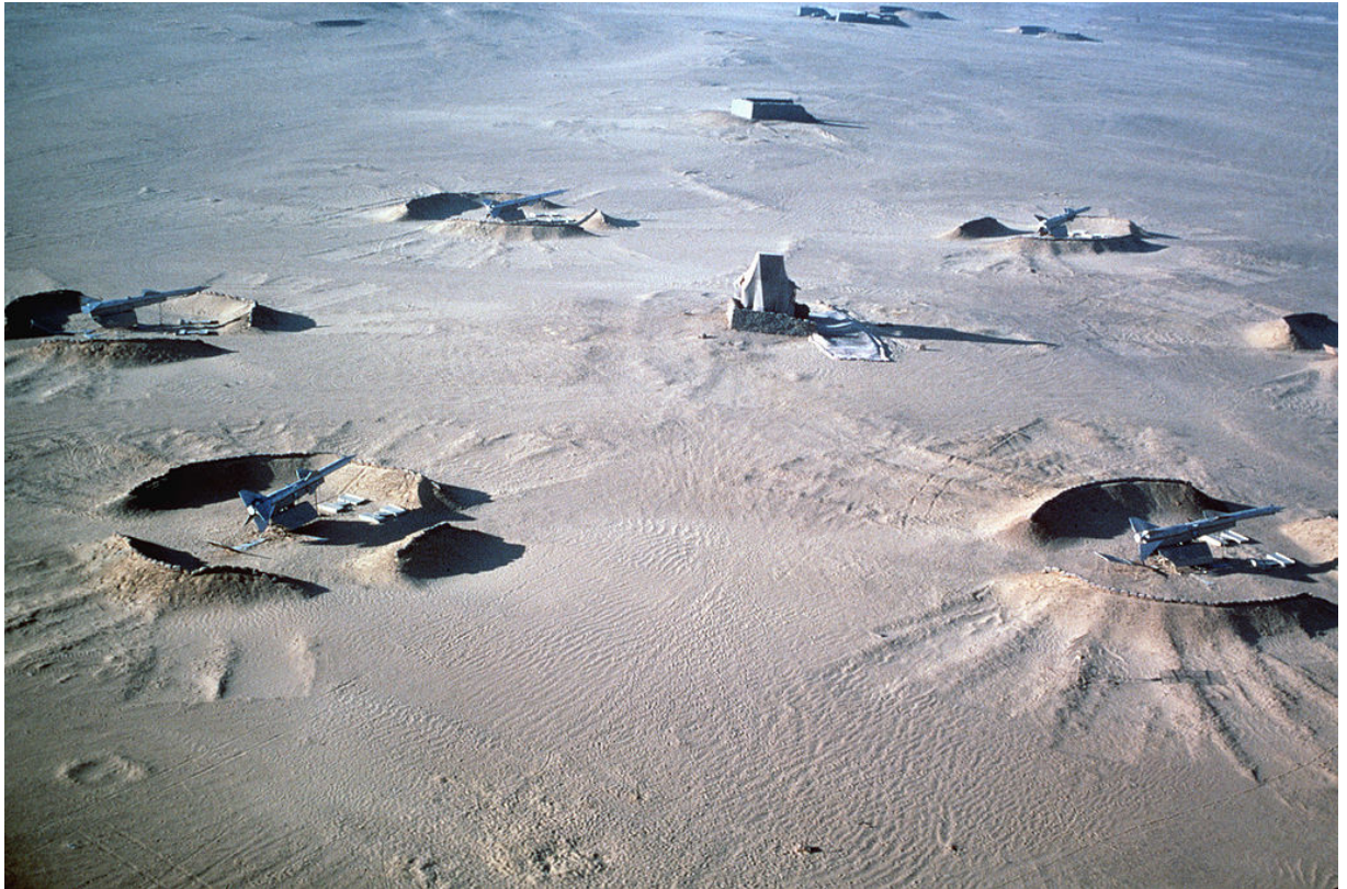
9.számú ábra: az SA-2 légvédelmi rakéták jellegzetes hatszögletű telepítési rendszere
