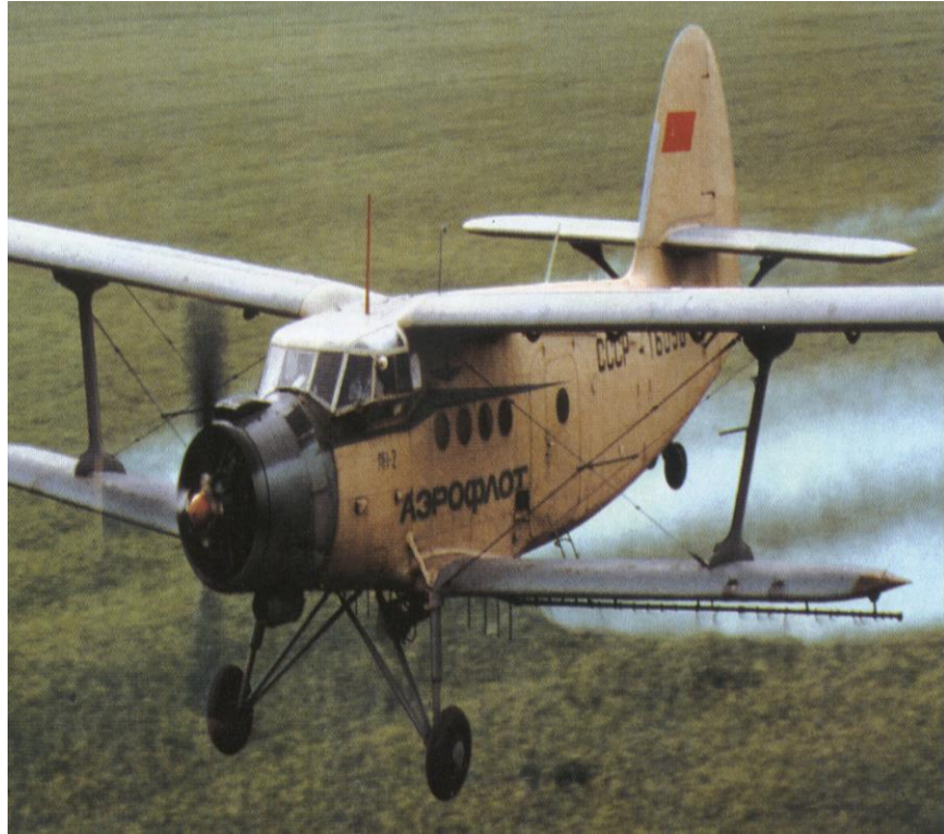
1. ábra. AN-2 „Colt” (szovjet) kétfedelű vízi repülőgép. (Itt permetező szerepben). Forrás: A világ repülőgépei. (Mester Kiadó, Budapest 2000-2005 – 8. csoport 7. kártya
