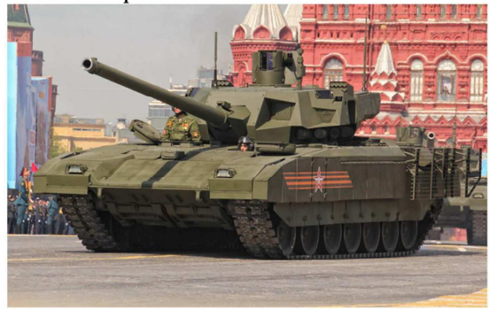
68. kép 2020-ig nagyarányú korszerűsítést akarnak végrehajtani az orosz haderőben. A képen a legújabb T-14 Armata harckocsi, amellyel a T-72/80/90-t váltanák le.
