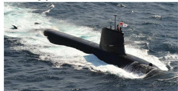
25. kép A Soryu-osztályú dízel-elektromos tengeralattjárók világszínvonalat képviselnek és hatékony tengeri ellenőrző, területmegtagadó és felderítő egységeket jelentenek a JMSDF számára.
