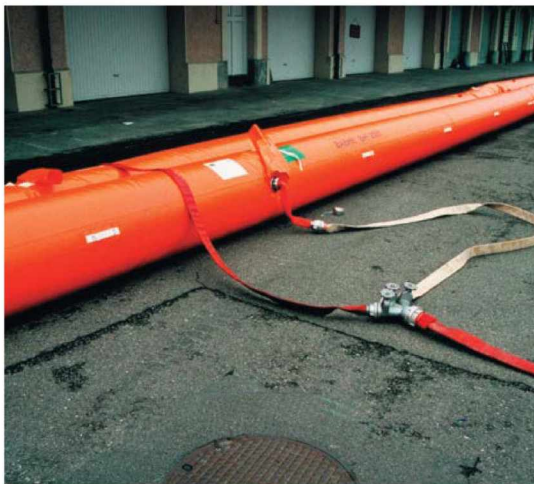
65. ábra: Tömlősgát összekapcsolása és feltöltése. (forrás: Polgári Védelemért Alapítvány [136])
