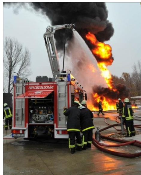
11. fénykép: Oltókarra épített Hydro-Chem ágyú; Forrás: FER Tűzoltóság
