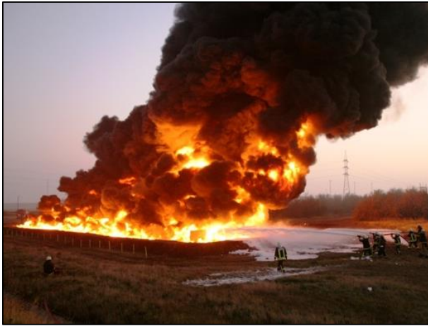
28. fénykép: Habterjedési kísérlet nehézhabbal; Forrás: FER Tűzoltóság
