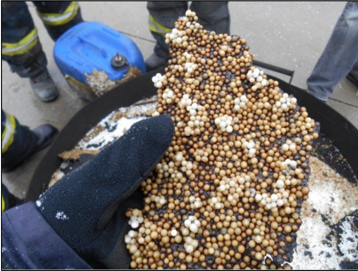
16. fénykép: A szárazhab-kéreg [68]
