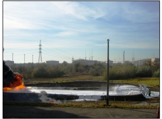
29. fénykép: Habterjedési kísérlet középhabbal; Forrás: FER Tűzoltóság
