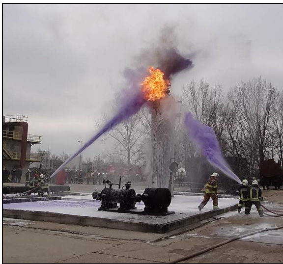
10. fénykép: Háromdimenziós tűz oltása Hydro-Chem sugarakkal; Forrás: FER Tűzoltóság
