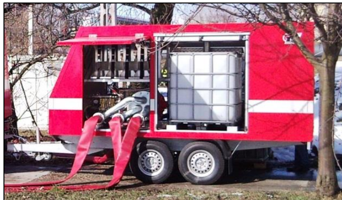
20. fénykép: Utánfutóra épített FireDos 10000-09S1-02 habbekeverő rendszer Forrás: FER Tűzoltóság 2012.
