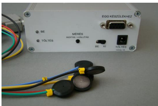
6. és 7. ábra: A 24 órás mérésre is alkalmas EIG készülék
