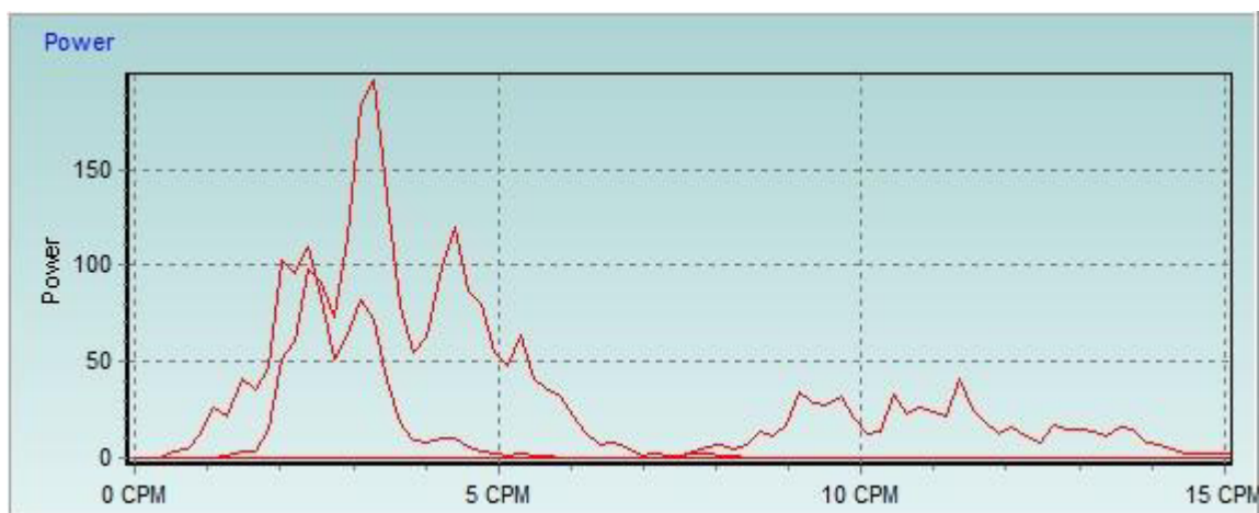
55. ábra: Séta közbeni ülés alatt készített felvétel a jobb alsó elektródán. Látható, hogy az egyes szakaszokból érkező jelek erőssége lényegesen eltérő.
