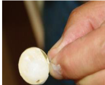
12. és 13. ábra: A testfelületről elvezethető bioelektromos jelek átvitelére szolgáló, elektrolit géllal töltött tányéreklektrodák
