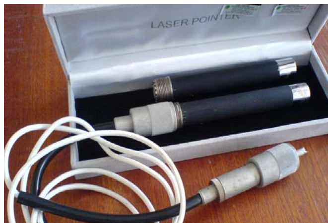
13. kép Modulált fény előállítására alkalmas átalakított lézerpointerek (A szerző felvétele)
