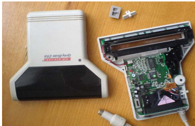
18. kép A felhasznált CCD sorkamera forrása (A szerző felvétele)
