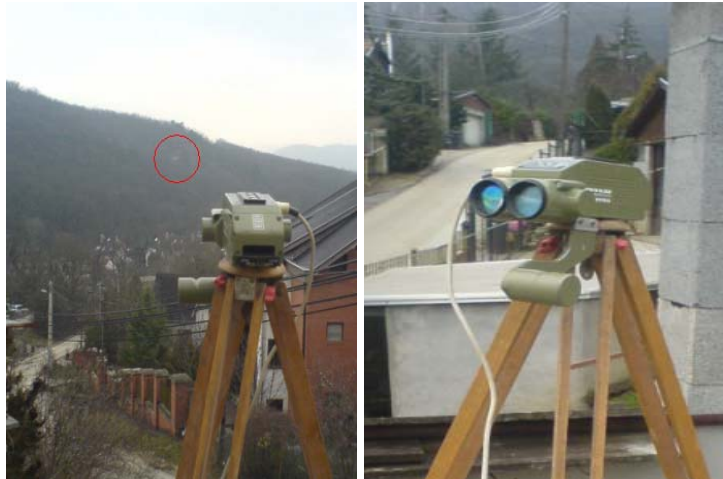
6. kép Távolságmérés Wild Distomat Di4-el (A szerző felvétele)
