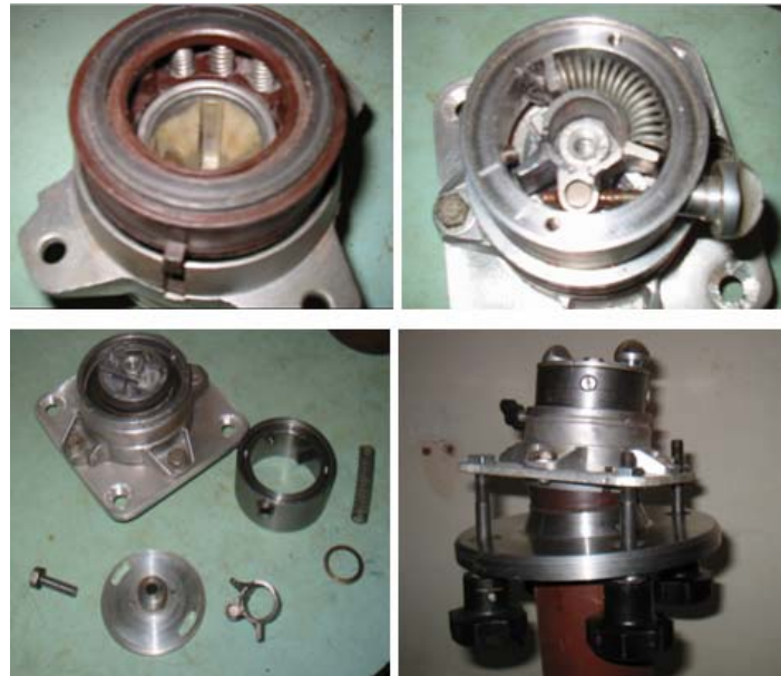
15. kép Beállító rugós szerkezet felépítése (a szerző felvétele)
