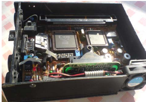
20. kép Felhasználásra kész mérővevő és adatgyűjtő (A szerző felvétele)
