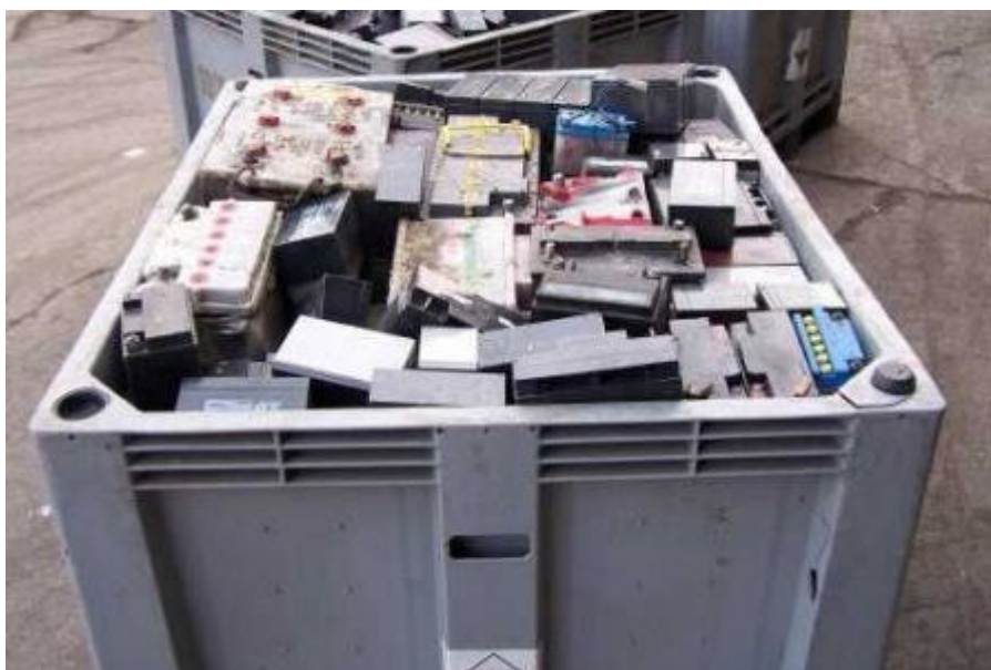
36. ábra: Savas akkumulátor hulladék tárolása a gyakorlatban [33]
