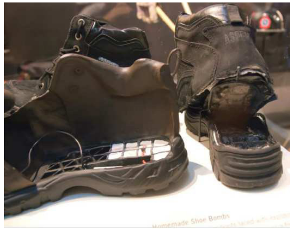
14. ábra Cipő sarkába rejtett robbanószerkezet [29]
