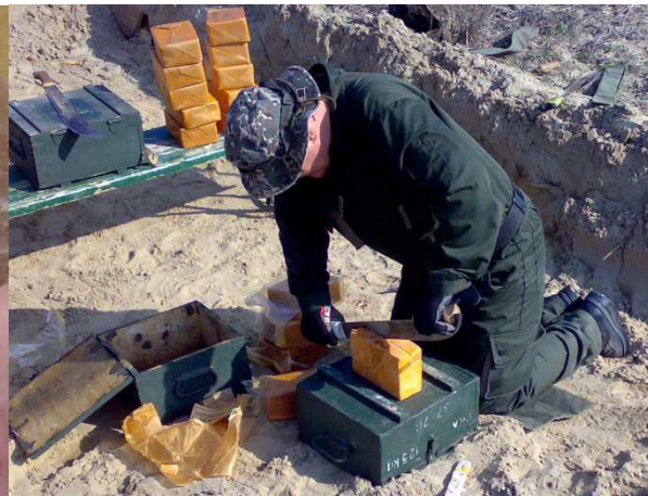
50. ábra Semtex vágása egyéni védőeszköz alkalmazásával, erre rendszeresített vágóeszkővel [7]
