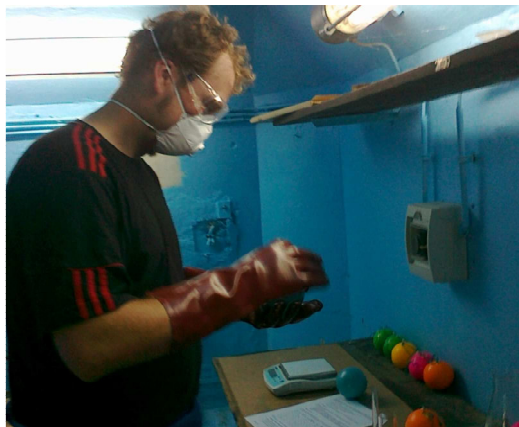
40. ábra Hexogén por kiserelése robbantási kísérletekhez [7]
