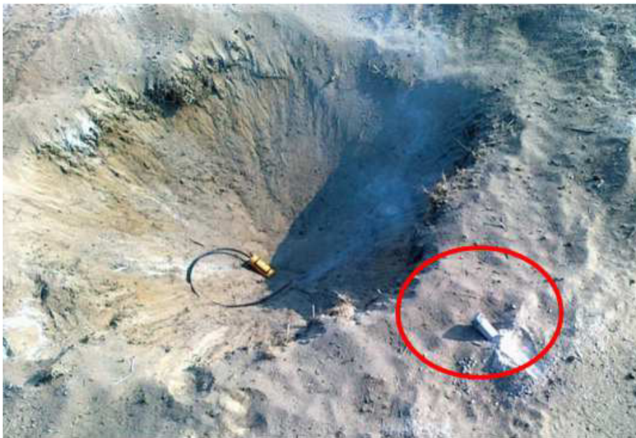
114. ábra 75 gr TNT préstest robbantás előtt, a gödör szélén a szén-monoxid mérő eszköz [7]
