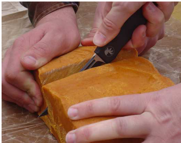
49. ábra Helytelen robbanóanyag kezelési gyakorlat [107]
