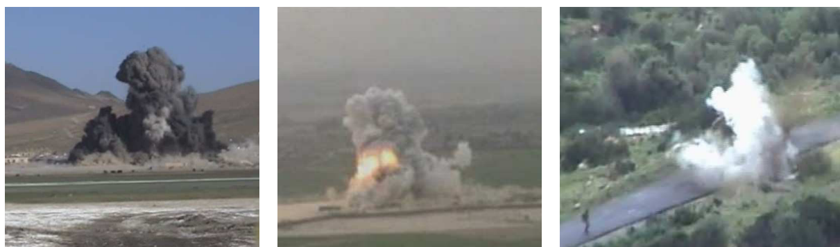
105. ábra TNT, ANDO, és házilag készített robbanóanyagok (TATP 72 ) különböző színű robbanásai [30]
