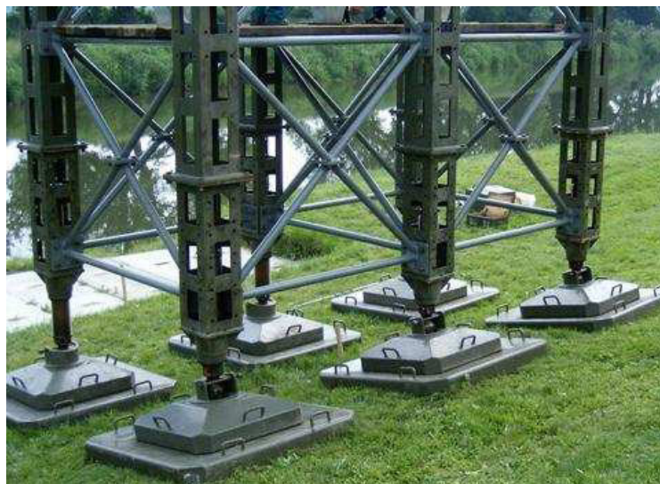
3.7 ábra: PIŽMO elhelyezése egyenetlen felületen a CSK Közlekedési Minisztérium kiképzőközpontjának gyakorlóterepén
