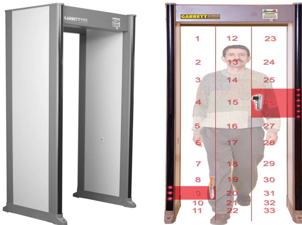
21. ábra Garrett fémkereső detektorkapu és a vizsgálati zónák illusztrációja [118.]
