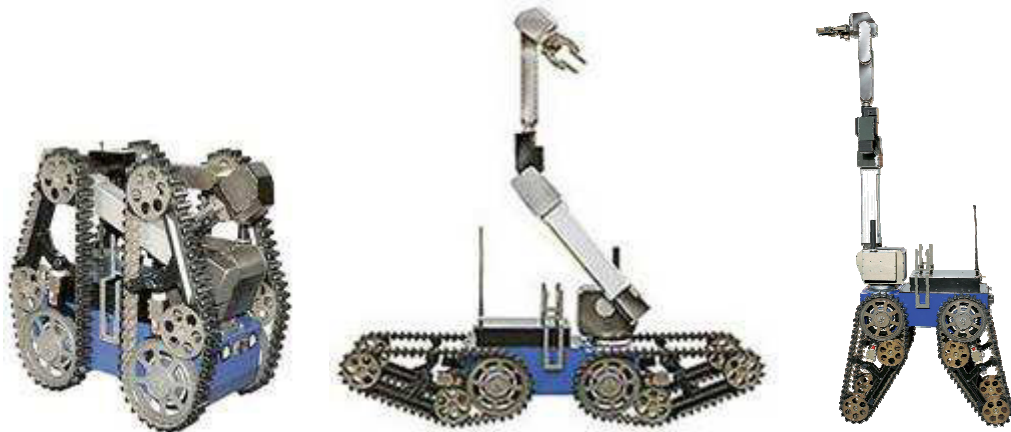
37. kép TELEX tűzszerész robot, szállítási, gyorsjáratú és álló helyzetben [128.]
