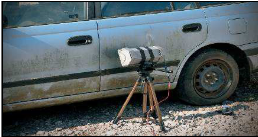
56. kép MajorMod folyadék-disruptor alkalmazás közben [153.]
