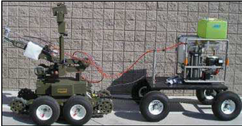
36. kép ANDROS F-6A által vontatott mini MACE vizes vágó utánfutóra szerelve [127.]
