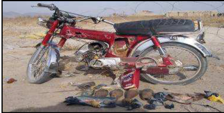
14. kép Motorkerékpárba rejtett katonai és improvizált robbanószerkezetek [54.]
