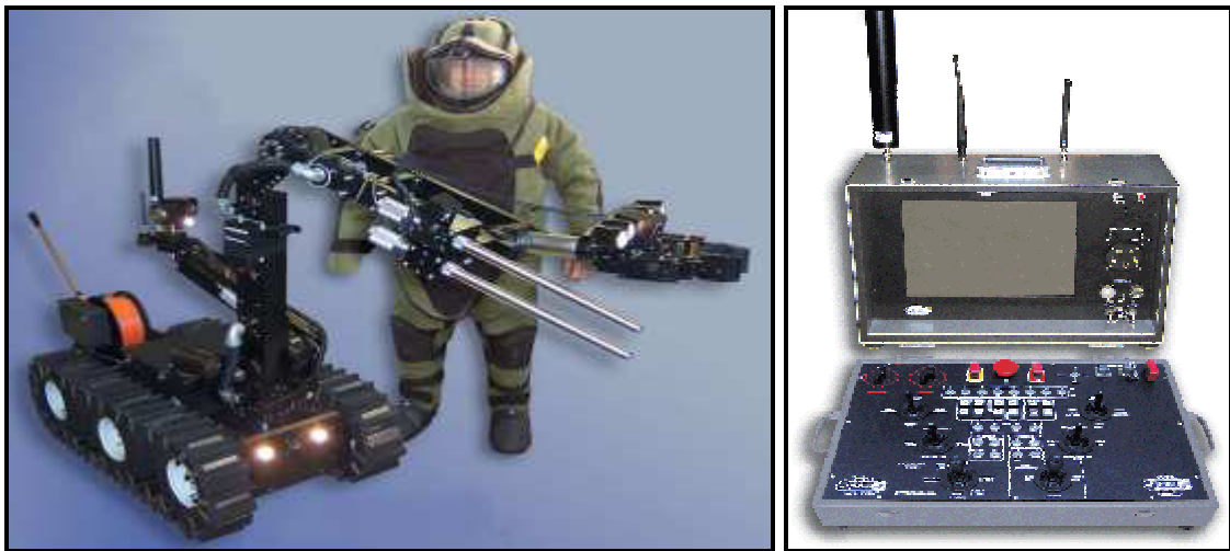
54. kép KNIGHT robot és az operátor vezérlőegysége [152.]
