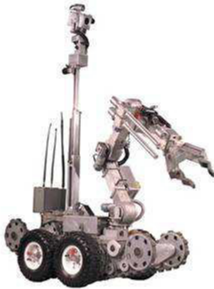
35. kép Az ANDROS F-6A nehéz tűzszerező robot [124.]
