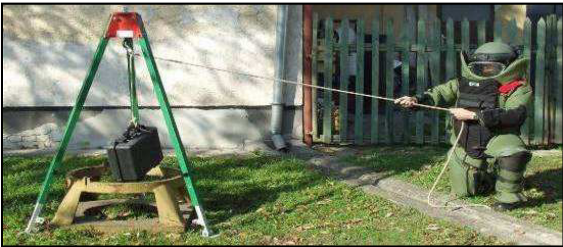
41. kép Emelőállvány alkalmazás közben 160
