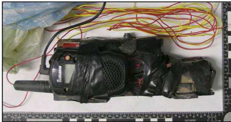
12. kép Rádió adó-vevő készülékkel felszerelt házilagosan készített robbanószerkezet [44.]
