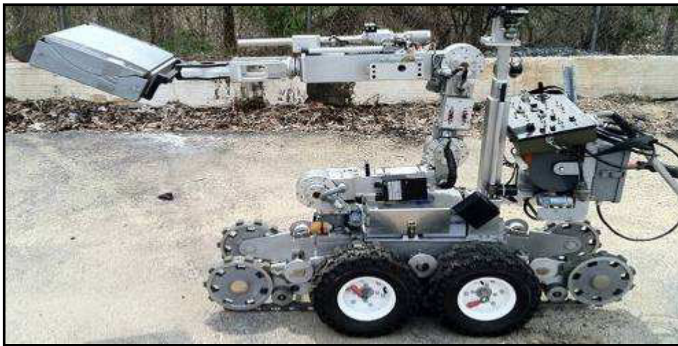
57. kép Andros F6–A tűzszerező robot BootBanger disruptort telepít [155.]
