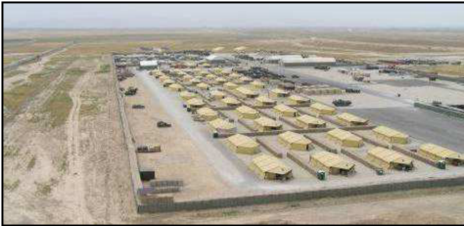
20. kép Tábor védelmi kialakítása Hesco-bástya alkalmazásával [86.]
