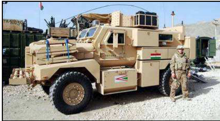
44. kép Speciális páncélozott tüzszerész jármű – Cougar 4 x 4 [136.]
