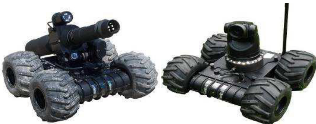
48. kép COBRA MK2 felderítő és hatástalanító robot disruptorral és kamerával [146.]
