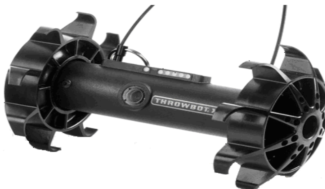
46. kép Throwbot XT – audio mikro robot [140.]
