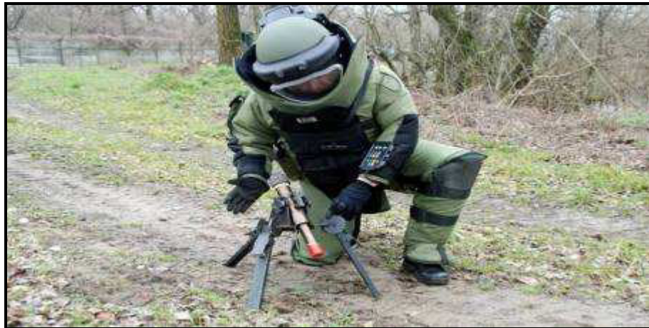
40. kép EG-2 disruptor alkalmazás közben [131.]
