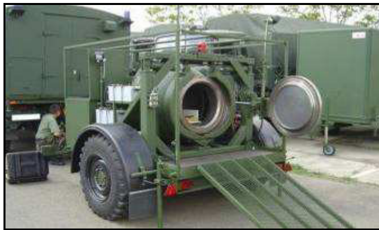
43. kép ARC–5R robbantó konténer [134.]
