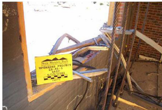
36. sz. ábra. Polimer réteg felhordása a falazatra és a teszt utáni állapot (forrás: http://www.linex.com/pages/2010/military/products/px_3350.php 2011. 05.05)
