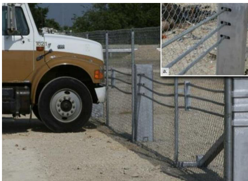
49. sz. ábra. A kis alapozási mélységet igénylő kerítés 1 méteren belül megállítja a teherautót (forrás: http://productsearch.bdonline.co.uk/HS-Jackson-&-Son-crash-rated-fencing-file014966.pdf 2010.07.13.)
