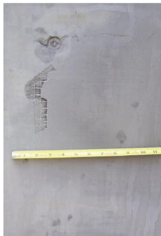
32. sz.ábra. A panelbe csapódó lövedék csak felületi sérülést okozott, a finom acélhálónak köszönhetően (forrás: http://www.ducon.eu/ 2010. 02.25.)
