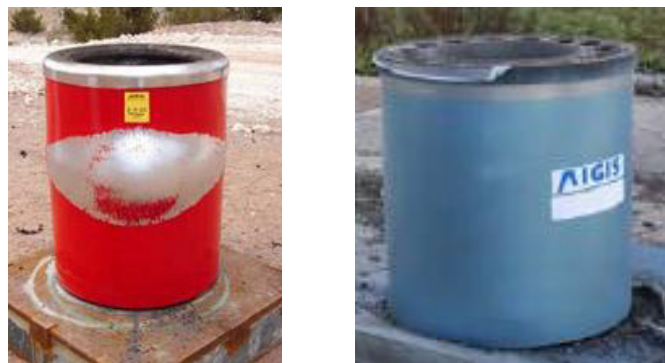
21.sz..ábra. Szemetes edények teszt utáni állapotban (forrás: http://www.zandz.hu/?Robban%E1sbiztos-szem%E9tkosarak&pid=249 2011. 06.05)
