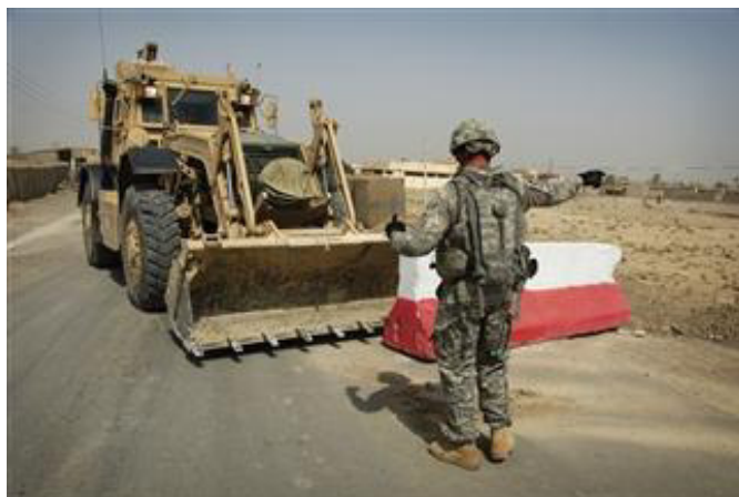
58. sz. ábra. Ellenőrző pont kiépítéséhez beton terelőt helyeznek el páncélozott buldózer segítségével (forrás: US DoD, Petty Officer 2nd Class Walter J. Pels, U.S. Navy)
