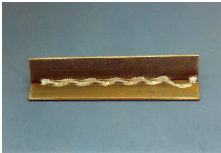
46. ábra. Nem megfelelő varratkövetés eredményeképpen létrejött egyenetlen varratvonal. 68
