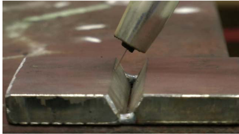
59. ábra. A lemezszél elhagyási pont (rövidzár megszűnik) 84
