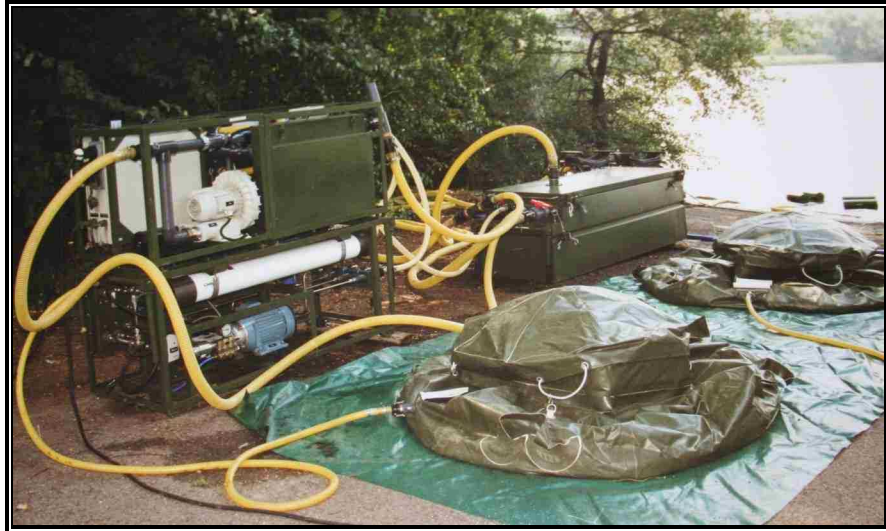
12. számú ábra: ZENON Mini-ROWPU mobil víztisztító berendezés 29
