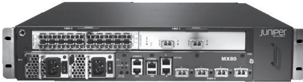
III-16. ÁBRA - NAGYKAPCSOLÁSI SEBESSÉGŰ 2U MAGAS ÚTVÁLASZTÓ[30]
