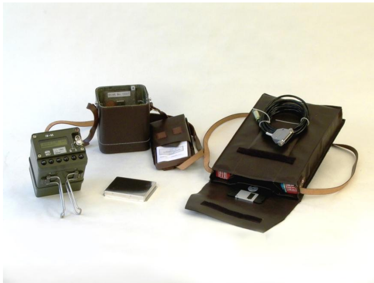
3. ábra. IH-95 sugárszint- és dózisteljesítmény mérő műszer (forrás: HAVÁRIA laboratórium)
