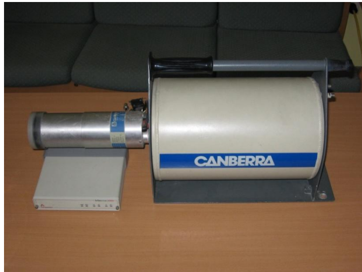
8. ábra. Canberra HPGe GC200 félvezetű detektor és a hozzá tartozó spektrum analízátor
