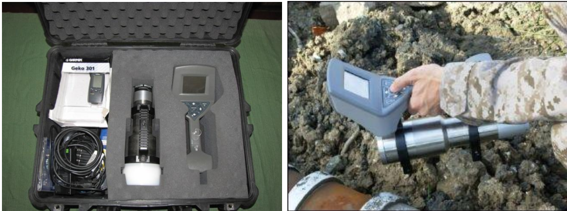
14. ábra. Berkeley SAM-940 hordtáskában (balra) és terepi mérés közben [11] (jobbra)
