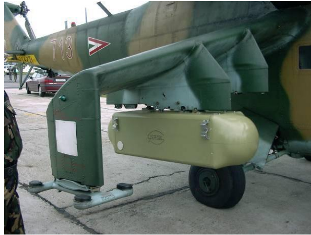
5. ábra. Légi sugárfelderítő konténer a MI-24-en [8]
