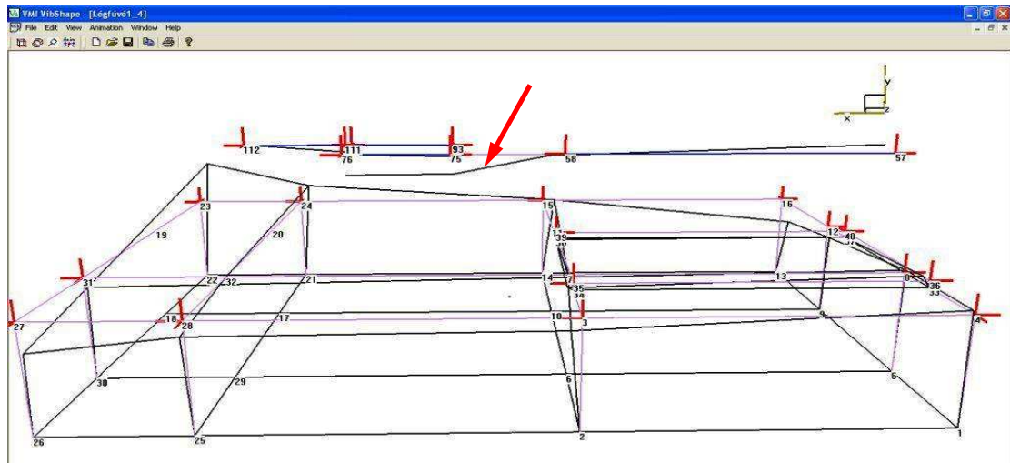
4.30. ábra A motor és hajtómű tengely-beállítási hibájára utaló animációs kép
