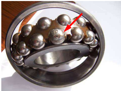
3.31. ábra A kiszertelt csapágy golyón látható pittingesedés [S26]
