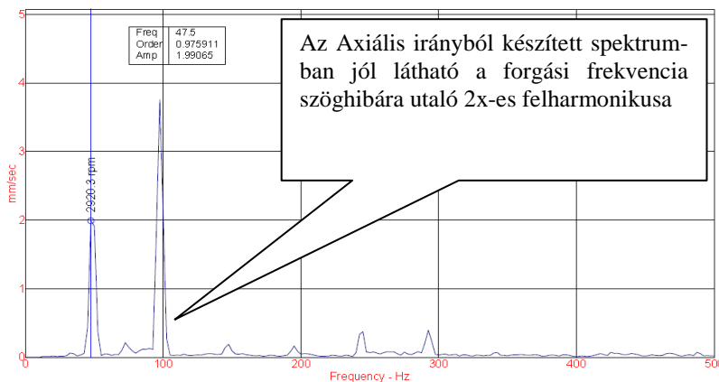
3.13. ábra Centrifugál szivattyú szöghibára utaló Axiális irányú rezgéssébség spektruma
