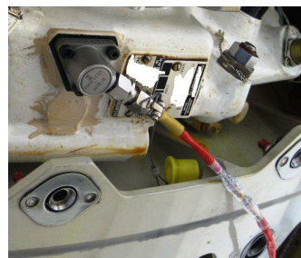
5.7. ábra Az érzékelők hajtóműházra és turbina csapágyzásra való rögzítésének megoldása.
