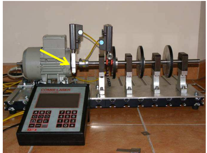
3.44. ábra A COMBI LASER műszer felszerelése a próbapadra.
