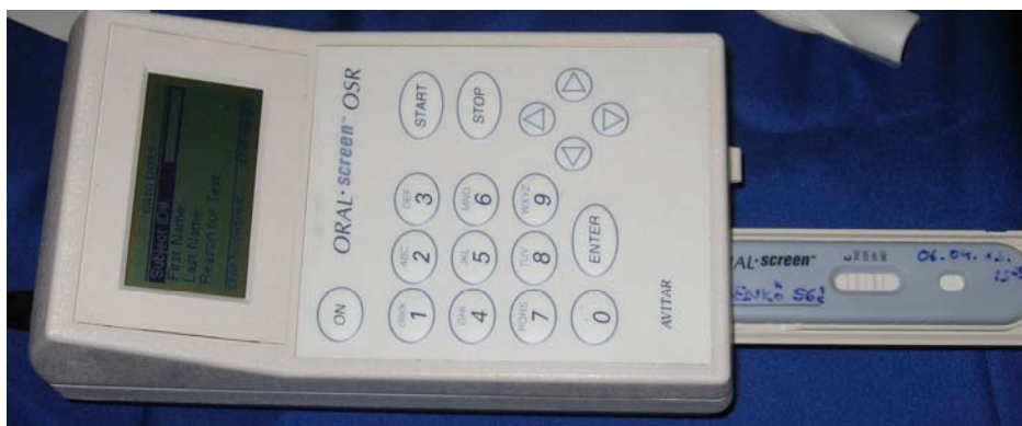
10. ábra. Az „off-line” rendszerű Oralscreen – ORS (Avitar) elektronikus kiértékelő
