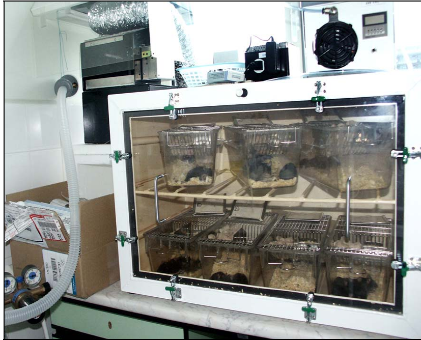
42. ábra. TE-10z Smoking Machine [Teague Enterprises, USA] teljes test dohányfüst-expozíciós készülék, laboratóriumi állatok számára. Légtartalma 78 liter, méretei 75 x 61 x 51 cm
