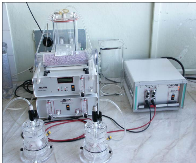
43/1. ábra Légzésfunkció változásának mérésére alkalmas pletizmográf
