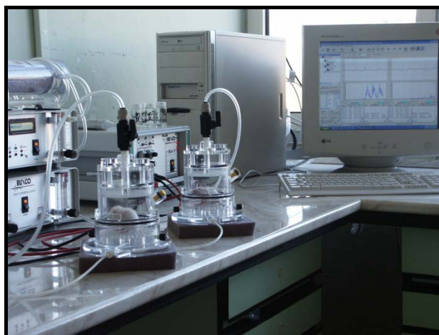
43/2. ábra. Éber egerek bronchiális reaktivitásának mérése Buxo teljes test pletizmográf készülékkel
