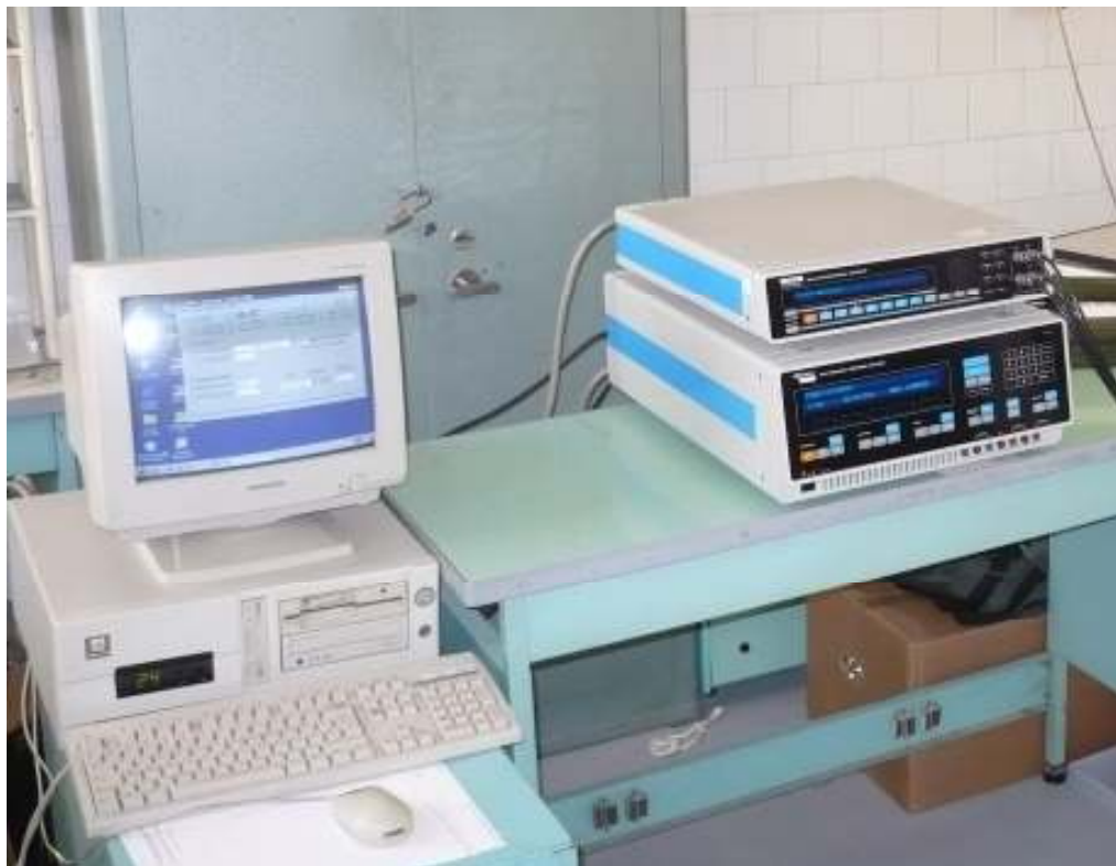
6. ábra Az impedancia spektrum mérésére használt berendezés
