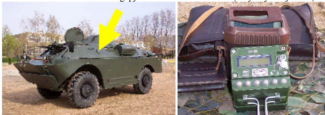
M2 ábra: A VSBRDM-2M gépjármű és IH-99D detektor (helye nyíllal jelölve)
