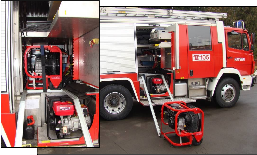
5. kép. Az MR TLF 2000 típusú gépjárműfecskendő átmenő fakkjában nagy szállított levegőteljesítményű mobil ventilátor is elhelyezhető. (Forrás: Saját.)
