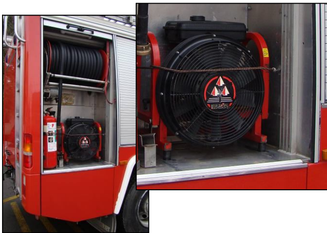
6. kép. A Mercedes–Rosenbauer TLF 4000 típusú gépjárműfecskendő jobbhátsó fakkjában közepes szállított levegőteljesítményű, mobil ventilátor helyezhető el. (Forrás: Saját.)
