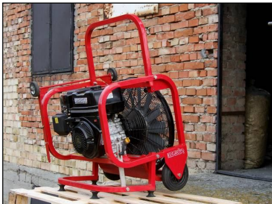
2. kép. LEADER GmbH gyártmányú MT 260 típusú turbóventillátor elhelyezése a beáramló nyílás előtt. (Forrás: Saját.)
