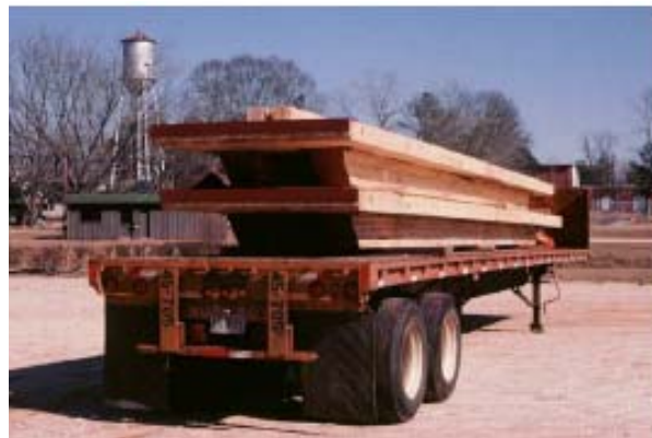
4-10. ábra: A hordozható híd utánfutón málházva 178
