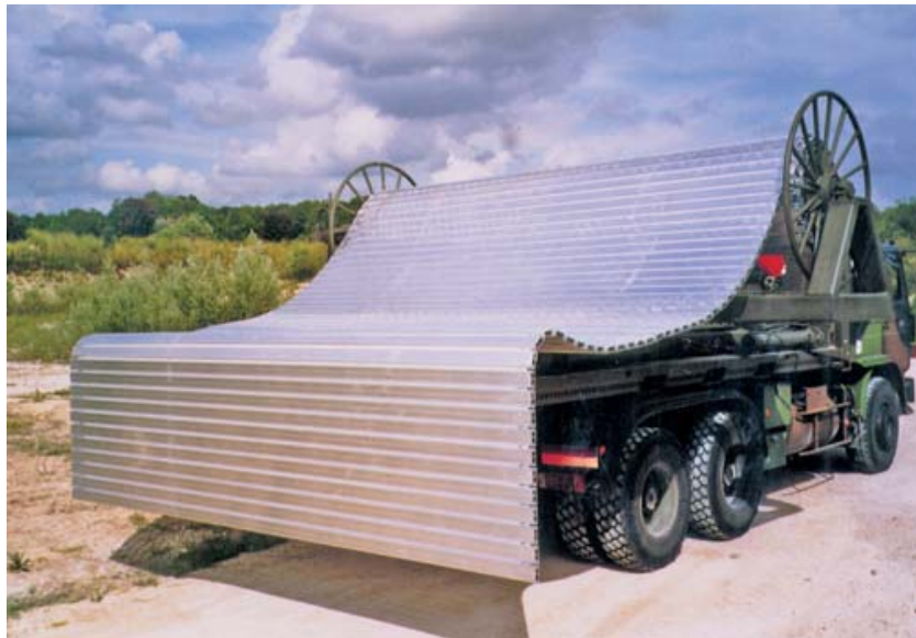
4-5. ábra: FCR gyors telepítésű kompozit (alumínium - műszaki szövet) szőnyeg telepítő gépkocsin 170
