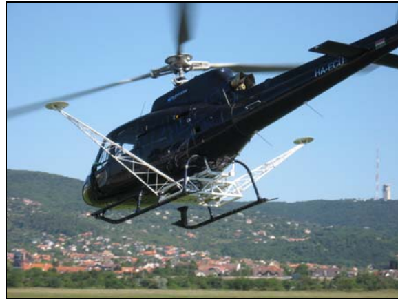
9. ábra: Légi lézerszkennér rendszer külső kerete a hordozó helikopteren. A törzs alatt a nagyfelbontású kamerák és lézer-detektorok vannak, oldalt a GPS-rendszer antennái (saját fotó)
