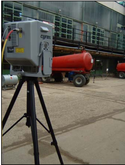
5. ábra (balra): Cyrax földi lézerszkennő egy vegyi üzem felmérésénél (saját fotó)
