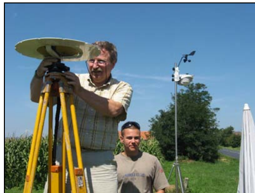
10. ábra: Légi lézerszkenneléshez kapcsolódó földi illesztőpont-mérés (saját fotó)
