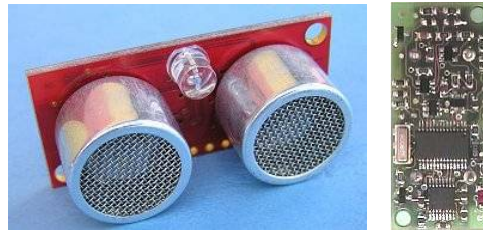
27. ábra. SRF08 ultrahangos távolságmérő modul [73]
