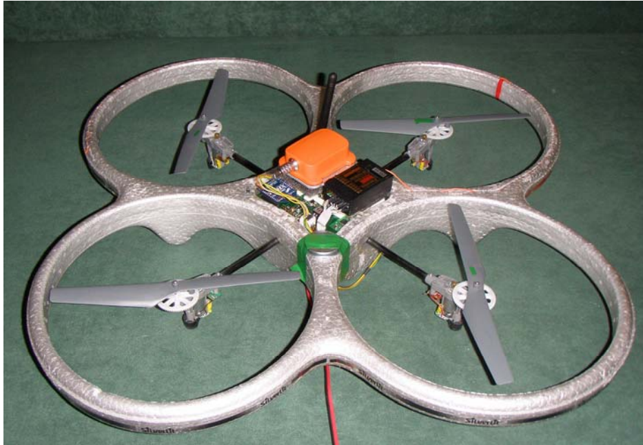
69. ábra. Kísérleti négyrotoros pilóta nélküli helikopter [Fényképezte: Turóczy A.]
