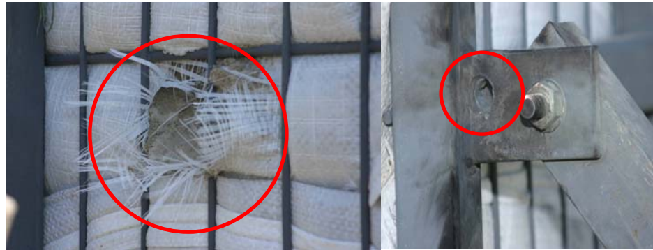
41. számú ábra Rombolópuska hatása (forrás: Callmix Kft.)
