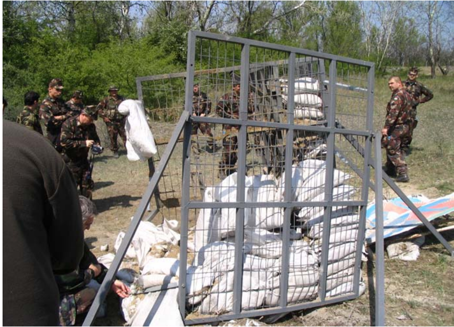
32-36. számú ábrák Védőfal az 5 kg-os FRT töltet robbantásakor (forrás: Callmix Kft.)
